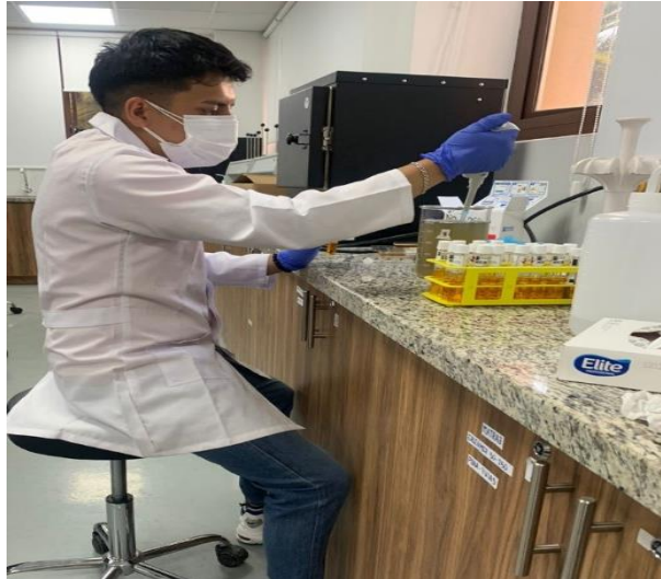
Imagen 35. Preparación de muestra (DQO)
