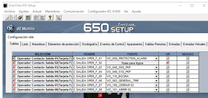
Figura 4.14: Configuración de parámetros generales del relé GE-F650 mediante software EnerVista ® Setup 650.
