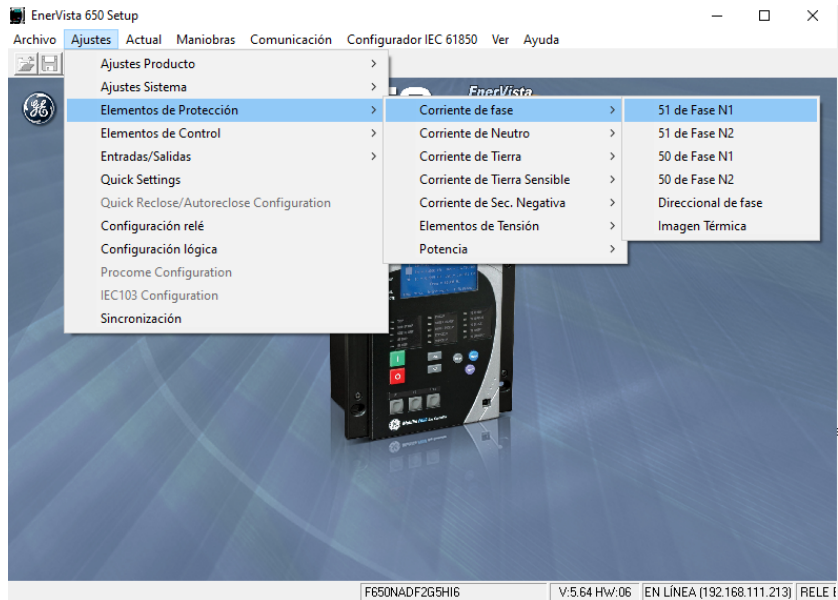
Figura 4.12: Selección de las funciones de protección 50/51 en el relé GE-F650 mediante software EnerVista® Setup 650 .
