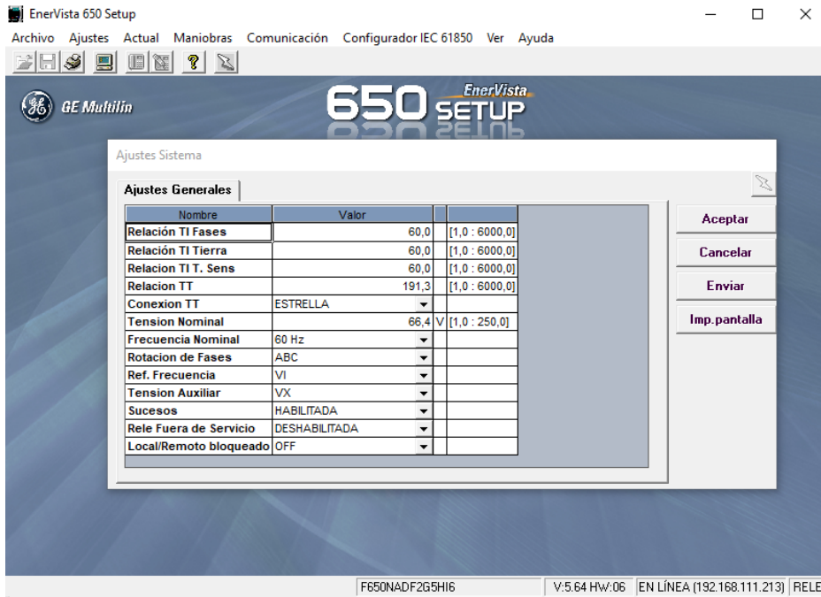
Figura 4.11: Ajustes de parámetros generales en el relé GE-F650 mediante software EnerVista® Setup 650.
