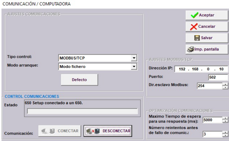
Figura 4.10: Comunicación del relé GE-F650 mediante software EnerVista® Setup 650.
