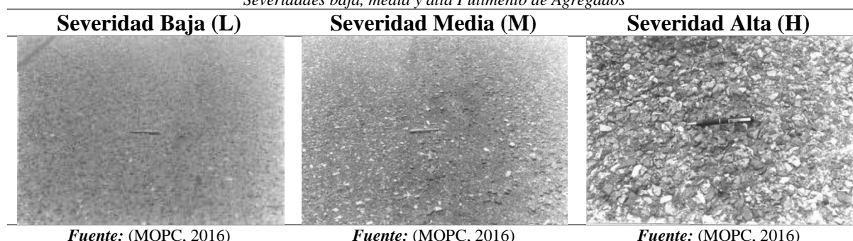
Ilustración 18 Severidades baja, media y alta Pulimento de Agregados
