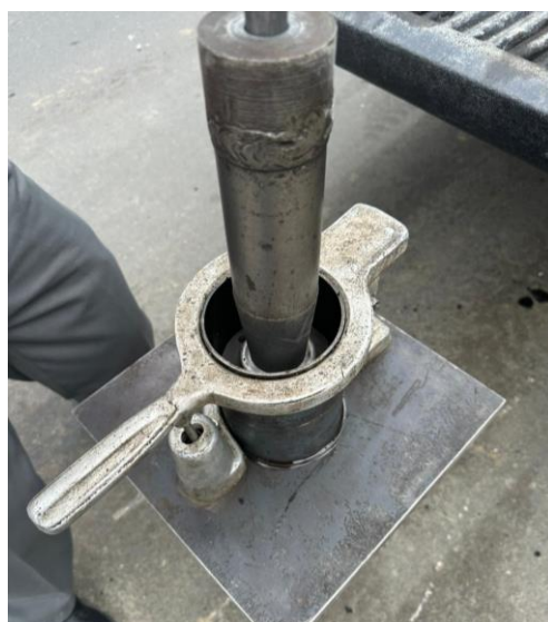
Figura 35. Compactación de especímenes mediante el Martillo Marshall
