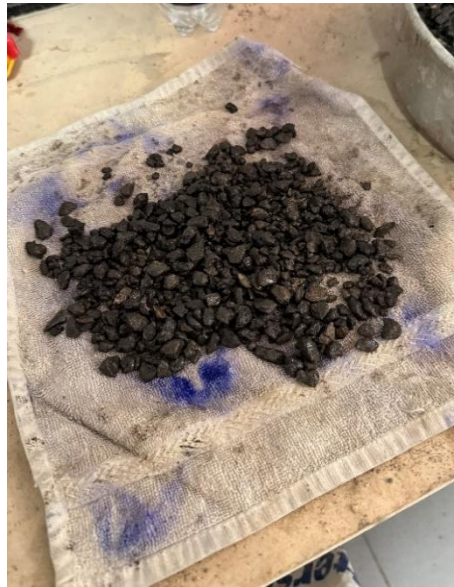
Figura 25. Condición Saturada Superficialmente Seca de la muestra RAP.
