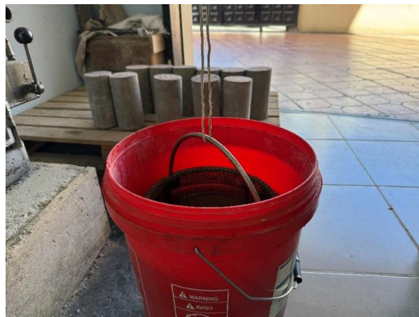
Figura 26. Pesaje Sumergido de la muestra RAP
