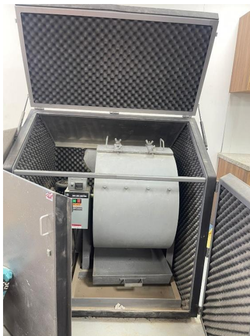
Figura 27. Preparación muestra RAP
