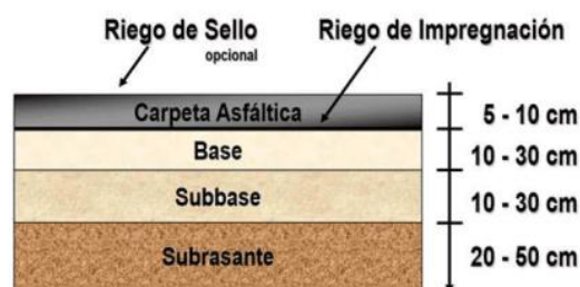
Figura 1. Estructura tipo de un pavimento flexible.
