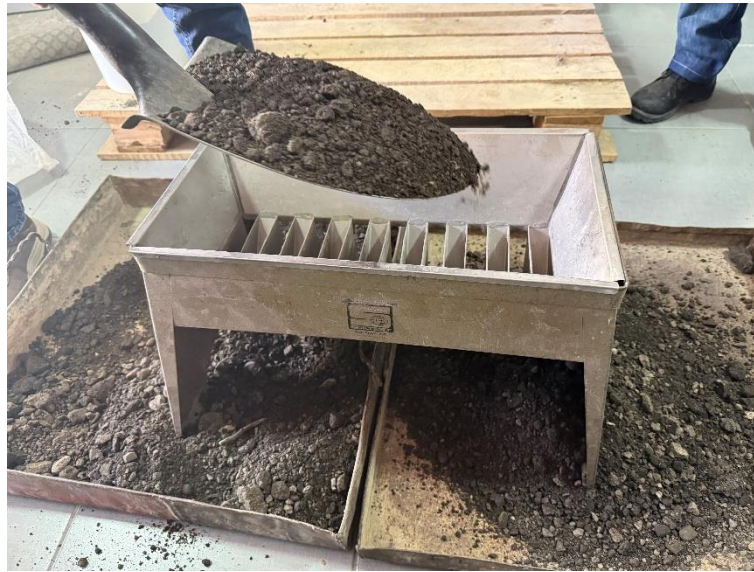
Figura 18. Preparación muestra y cuarteo
