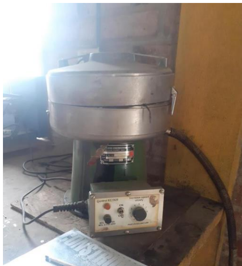
Figura 28. Preparación del Centrifugado para muestra RAP
