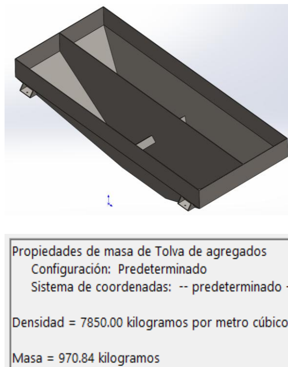
Figura 12. Diseño final de la tolva con sus características.
