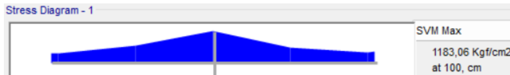
Figura 75. Esfuerzo en la Viga central.
