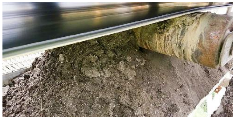
Figura 5. Acumulación de residuos en bandas transportadoras planas [15].
