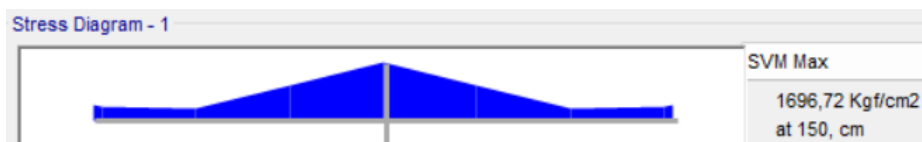
Figura 64. Viga de carga del nivel superior.
