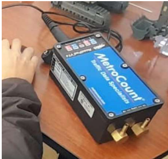
Ilustración 22: Cable de comunicación al equipo. Elaborado por: Autores
