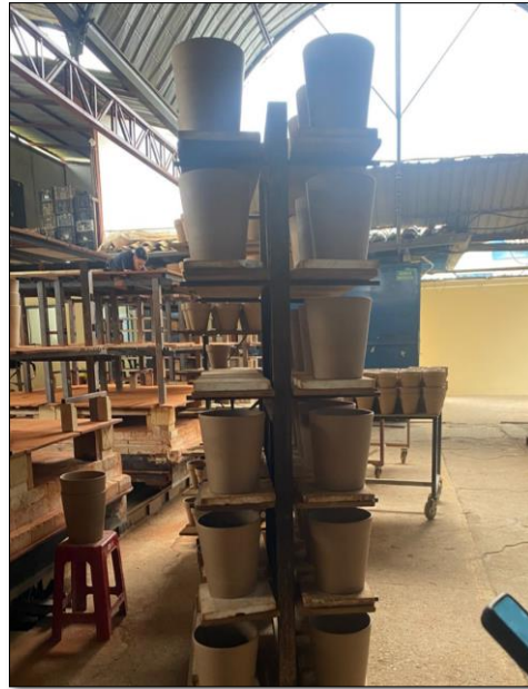
Figura 5. Racks de secado de piezas conformadas planta Mestiza® S.A.
