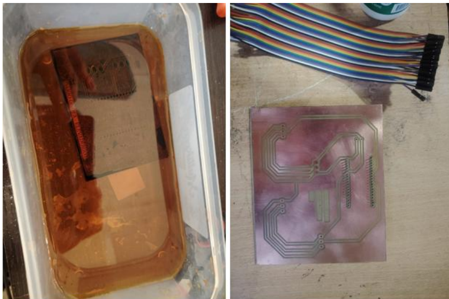
Referencia: Placa en ácido para crear la pista.
