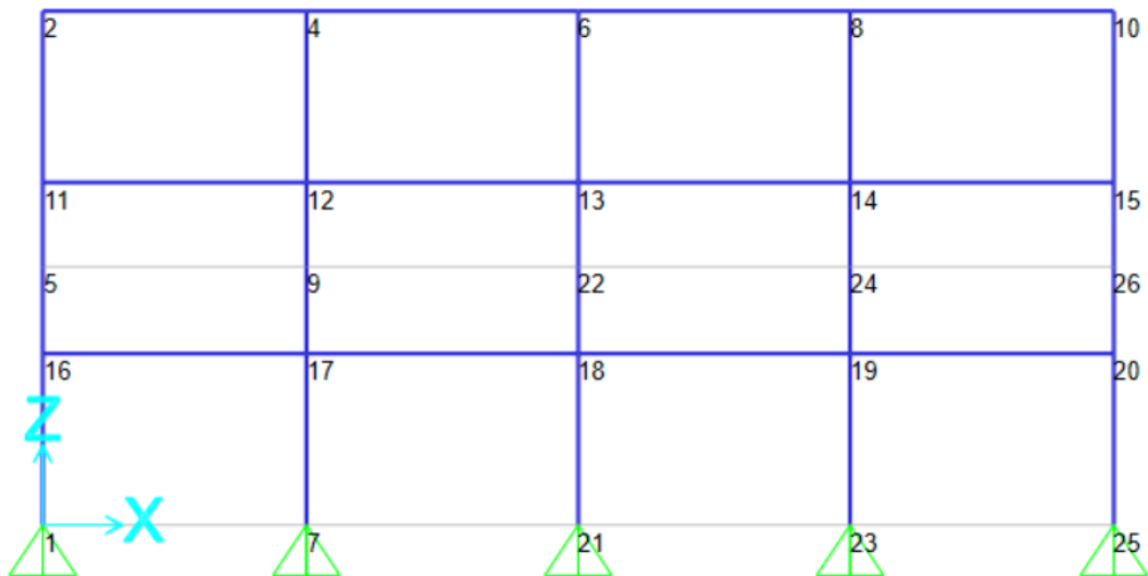
Figura 31. Configuración de nodos Sap2000 – Caso 2.
