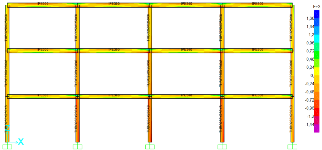
Figura 25. Esfuerzo combinación 5 Sap2000 – Caso 1.
