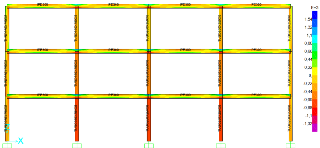
Figura 24. Esfuerzo combinación 2 Sap2000 – Caso 1.
