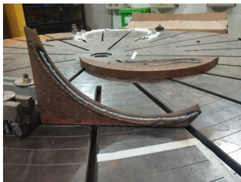
Figura. 87 Resultado de soldadura en superficie curva vista lateral
