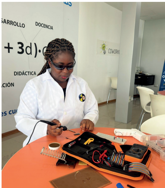
FIGURA 1 Karla suelda pines de Arduino Pro Mini
