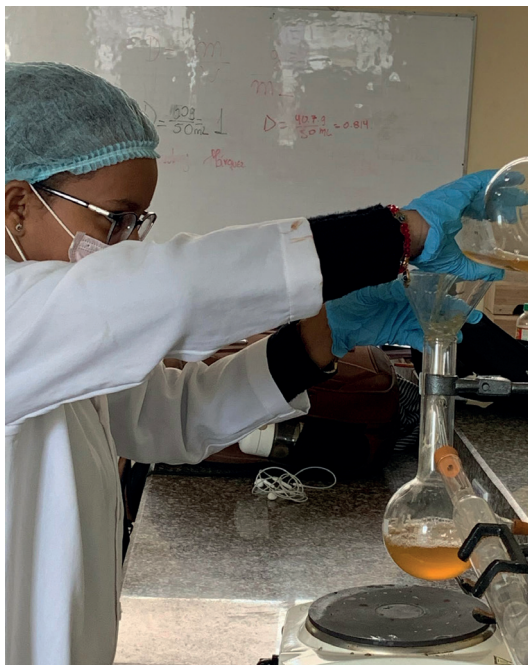
FIGURA 1 Destilación de alcohol etílico en laboratorio: experimento con levadura
