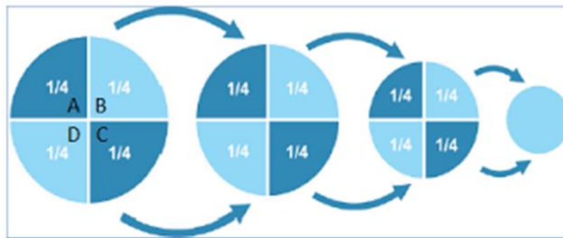
Ilustración 8. Método del cuarteo
