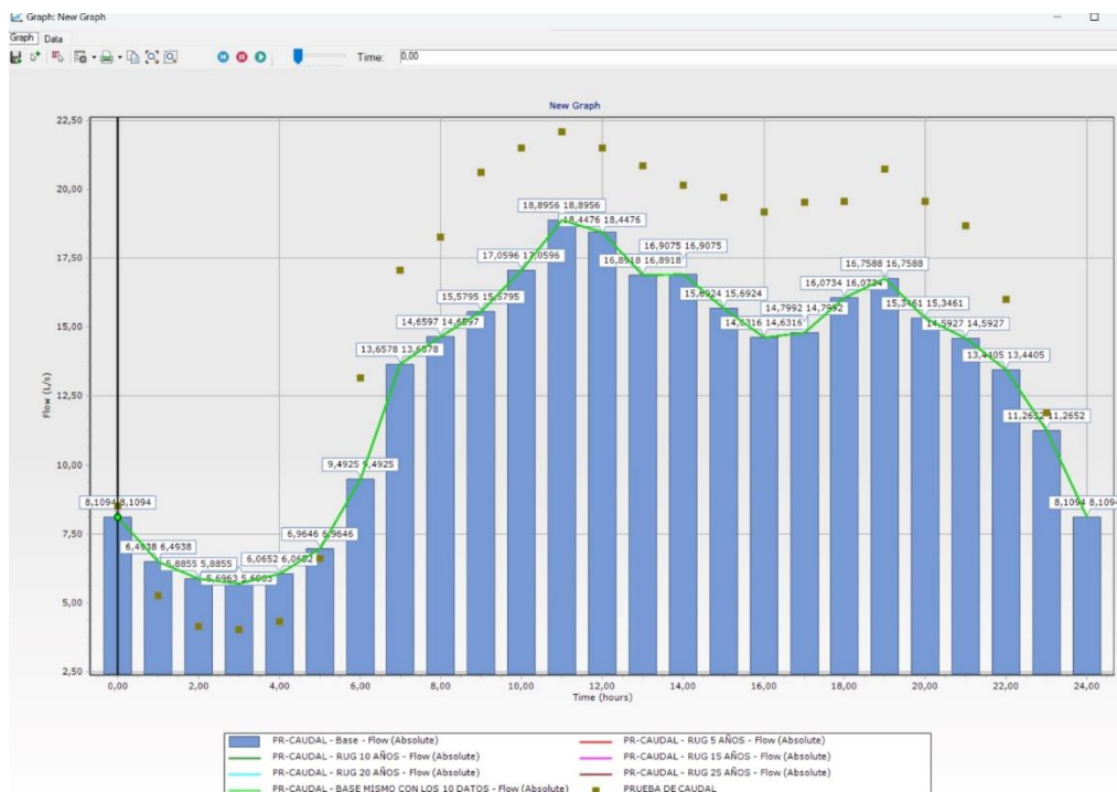
Ilustración 13 Comparación gráfica de caudales simulados vs medidos para distintos niveles de rugosidad
