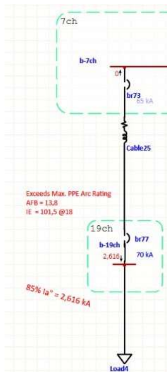
Figura 35. Tablero 19ch ETAP
