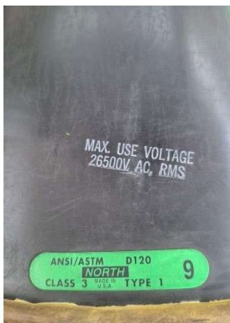
Figura 74. Guantes dieléctricos clase 3 para trabajos en media y alta tensión. Tipo 1
