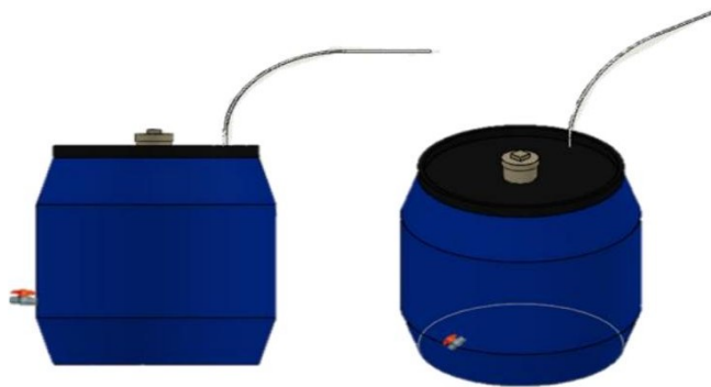
Figura 11. Biodigestor de flujo discontinuo
