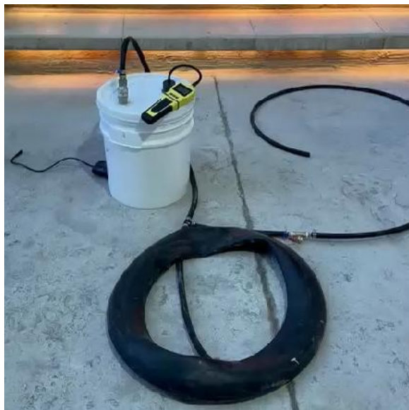
Figura 12. Biodigestor de flujo discontinuo
