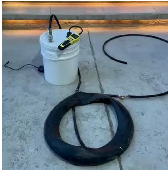
Figura 10. Biodigestor de flujo discontinuo
