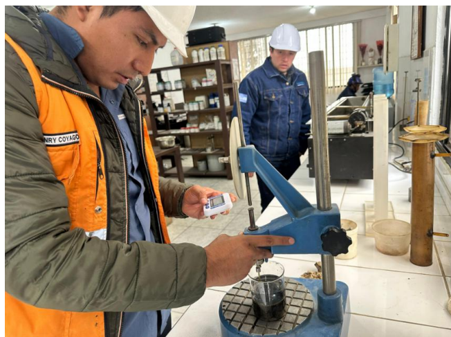
Ilustración 57. Liberación de la aguja segundos sobre la muestra por cinco.
