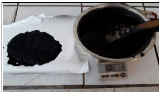
Ilustración 67. Registro del tiempo de rotura de la mezcla de micropavimento.
