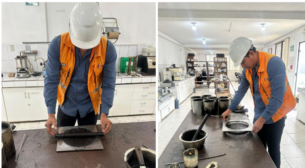
Ilustración 75. Colocación de la muestra de micropavimento en el molde.
