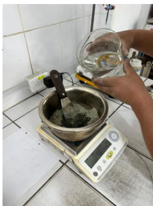
Ilustración 78. Preparación de la mezcla de micropavimento.
