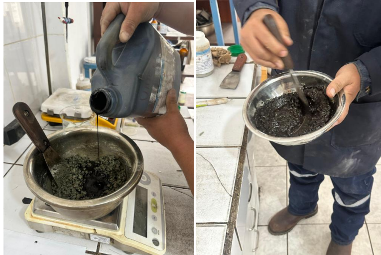
Ilustración 74. Preparación de la mezcla de micropavimento para el ensayo.
