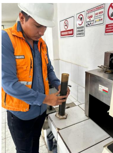
Ilustración 48. Colocación de emulsión asfáltica en la probeta graduada.
