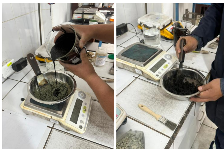
Ilustración 66. Mezcla de los diferentes componentes de la mezcla de micropavimento.
