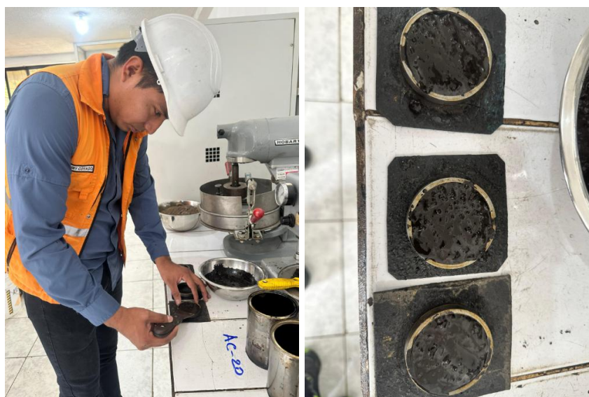
Ilustración 68. Colocación de mezcla de micropavimento en los moldes.
