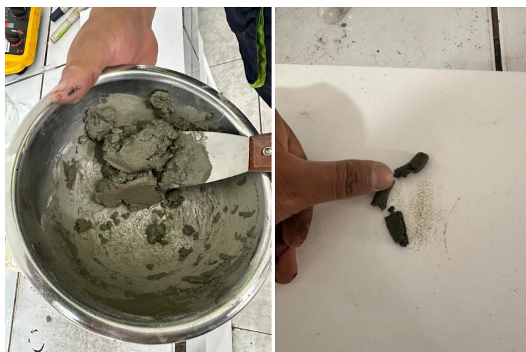
Ilustración 34. Material no muestra cohesión para formar los rollos.
