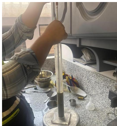
Ilustración 44. Uso del irrigador para limpiar las paredes de la probeta.
