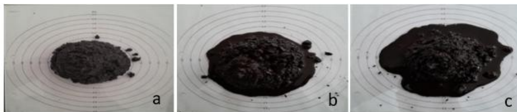
Ilustración 62. Ensayo de consistencia para diferentes porcentajes de agua añadida. a) 8% Agua añadida b) 9% Agua añadida c) 10 % Agua añadida
