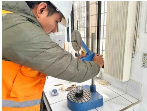
Ilustración 55. Colocación del asfalto en el equipo de medición.
