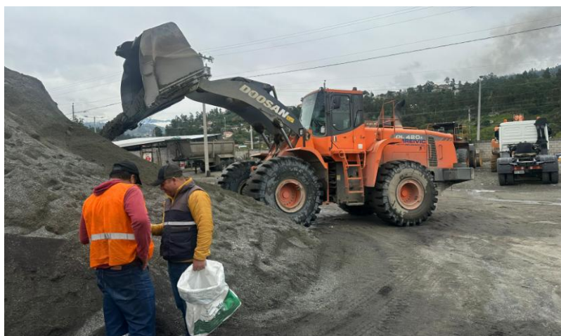
Ilustración 20. Toma de muestra del agregado cantera San José - Tenguel.
