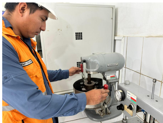
Ilustración 77. Colocación de la probeta en el dispositivo de abrasión.
