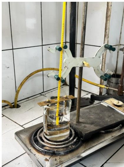
Ilustración 51. Calentamiento de la muestra junto con las bolas de acero.
