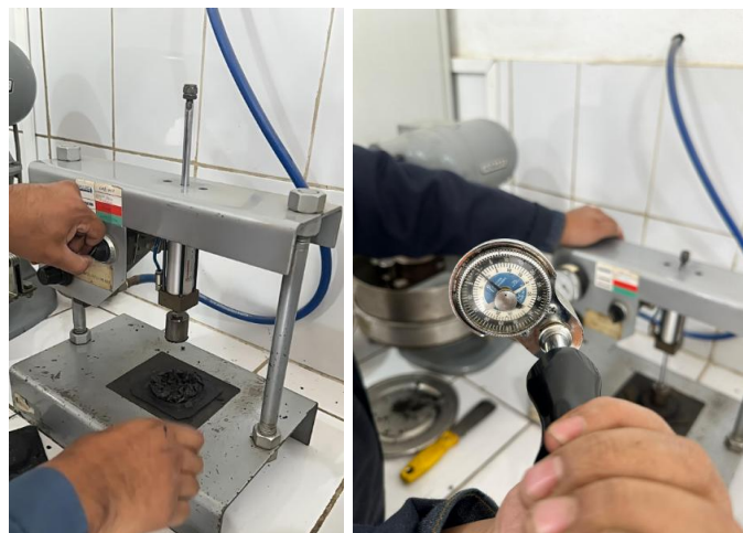
Ilustración 71. Registro del valor de torque alcanzado.
