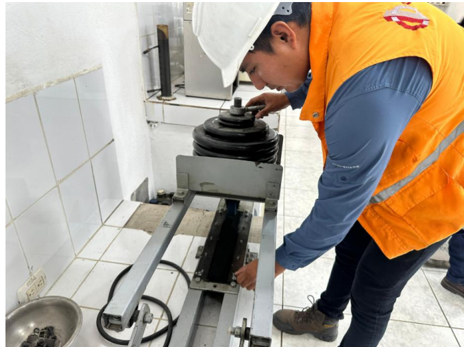
Ilustración 81. Colocación de la rueda de carga sobre la probeta.
