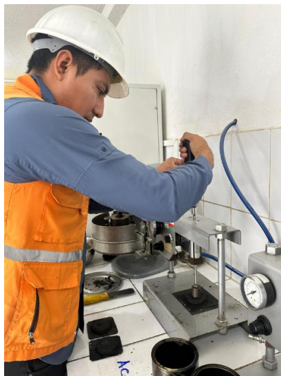
Ilustración 70. Ensayo mediante giro en el torsiómetro.
