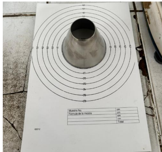
Ilustración 59. Cono de metal y escala de flujo para ensayo.
