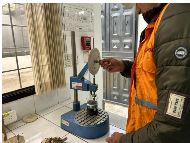
Ilustración 58. Registro de valores de penetración.
