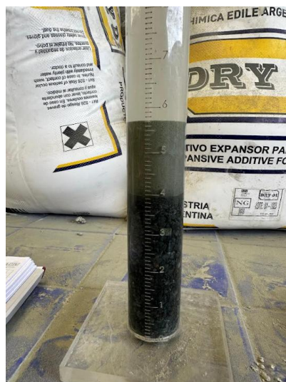
Ilustración 45. Registro de altura para cálculo del equivalente de arena.
