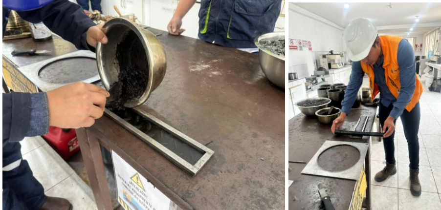
Ilustración 79. Colocación de la mezcla de micropavimento en el molde.
