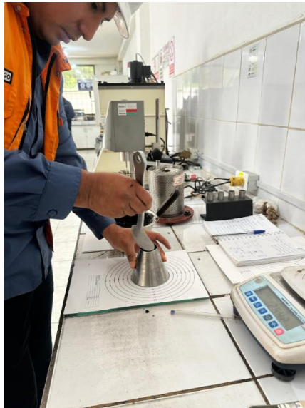
Ilustración 61. Colocación de la muestra dentro del cono metálico.
