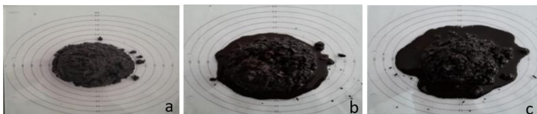
Ilustración 64. Ensayo de consistencia para diferentes porcentajes de agua añadida a) 8% Agua añadida b) 10% Agua añadida c) 11 % Agua añadida
