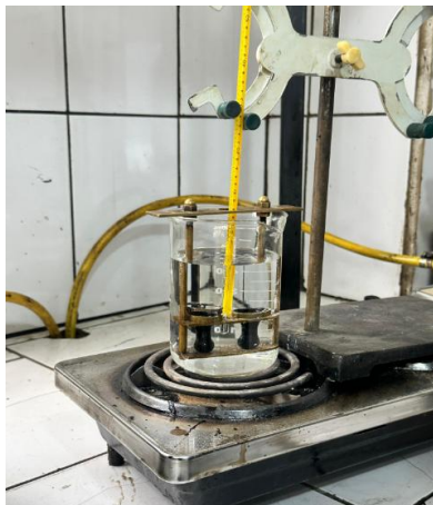
Ilustración 52. Desplazamiento de la bola al fondo y toma del registro de la temperatura.
