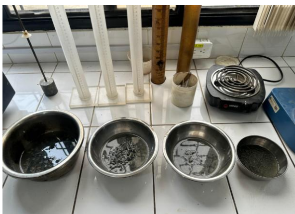
Ilustración 35. Saturación de las muestras por 16 horas.
