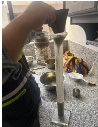
Ilustración 43. Colocación del material en probeta para ensayo.
