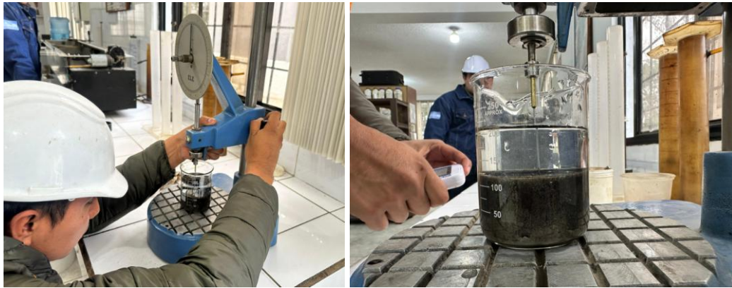
Ilustración 56. Descenso de la aguja hasta la superficie de la muestra para medición.
