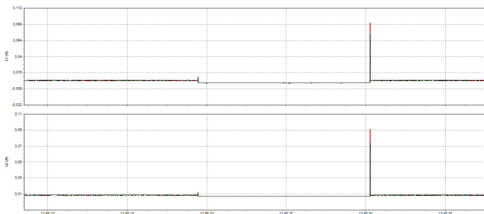
Figura 3.8: Corriente de arranque en luminarias LED.
