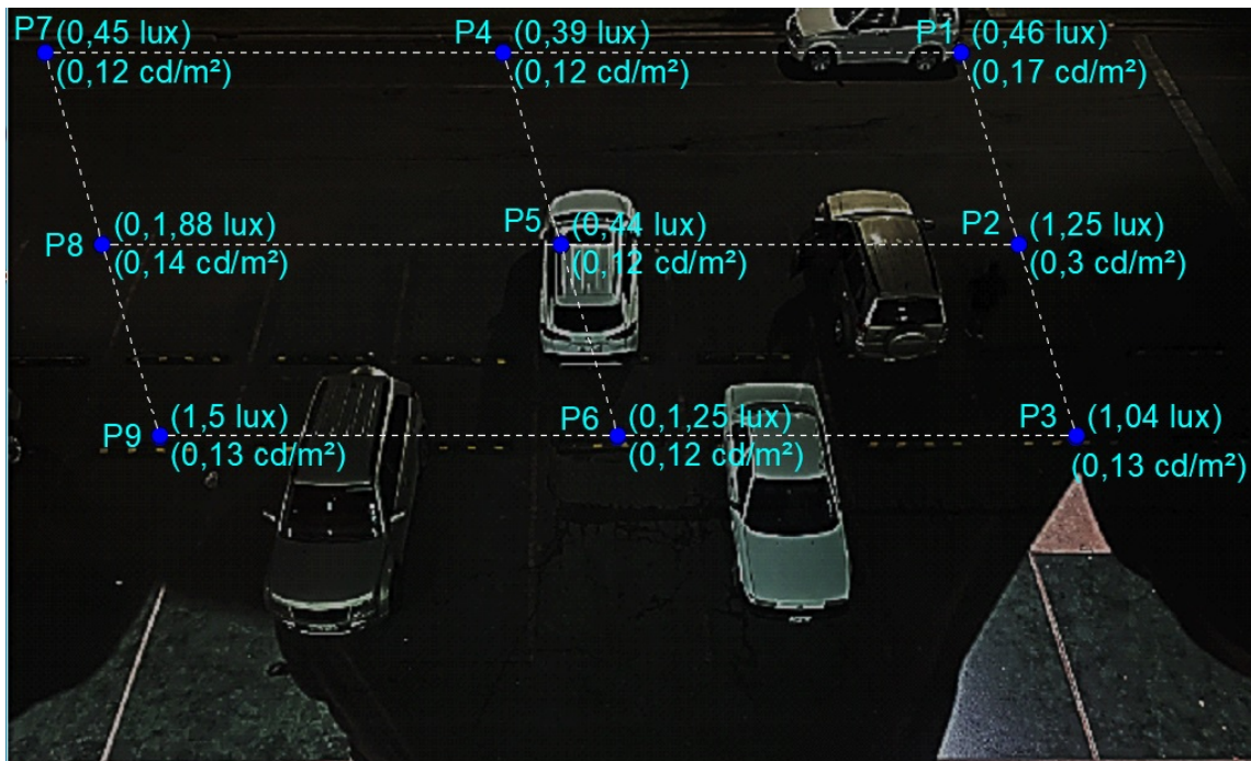
Figura 2.2: Valores obtenidos en el lugar de estudio implementando el método de los 9 puntos con luminarias apagadas.
