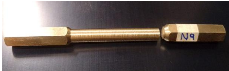
Figura 75. Segunda probeta N9 en bronce naval luego del ensayo.
