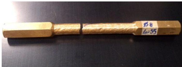
Figura 70. Probeta N7 en bronce fosfórico luego del ensayo.
