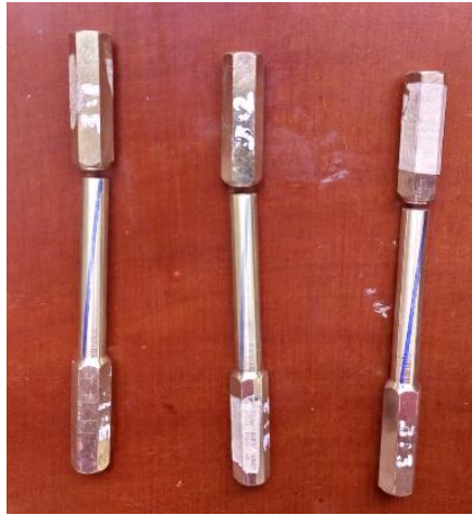
Figura 67. Ensayo de probetas de bronce naval N7.
