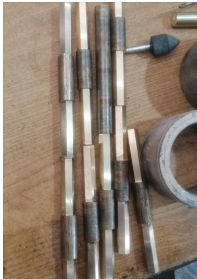
Figura 37. Fresado hexagonal del bronce fosfórico.
