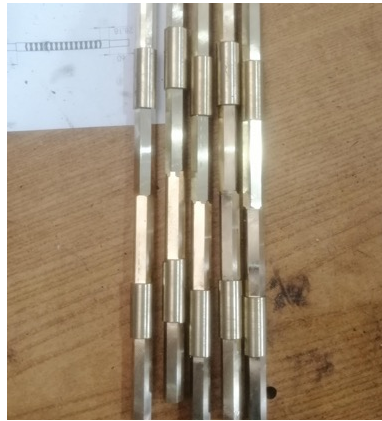
Figura 36. Fresado hexagonal del bronce naval.
