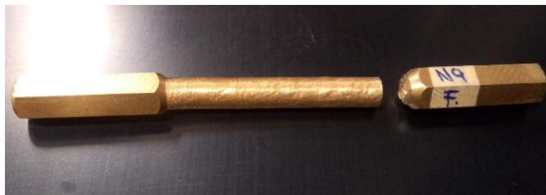
Figura 73. Tercera probeta N9 en bronce fosfórico luego del ensayo.
