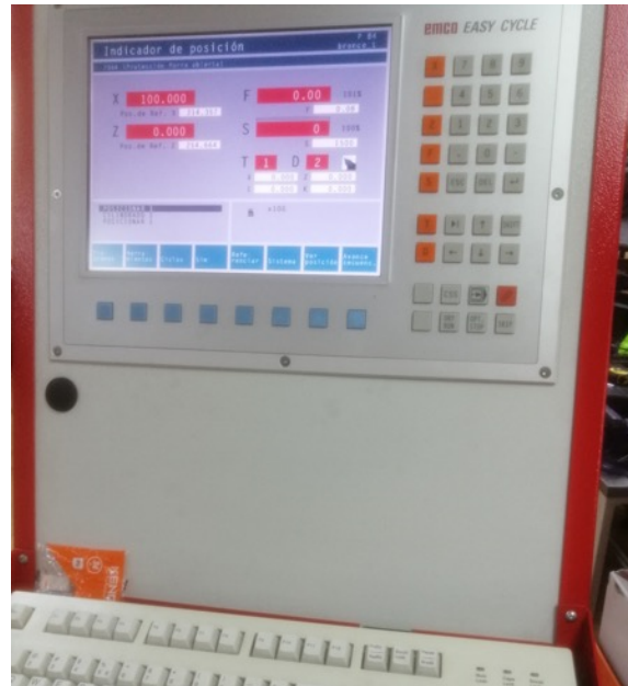
Figura 38. Unidad de control CNC durante el mecanizado de las probetas.
