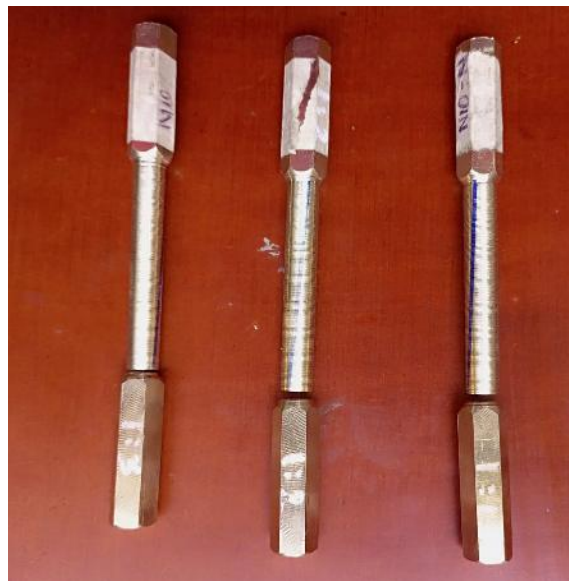
Figura 66. Ensayo de probetas de bronce naval N10.
