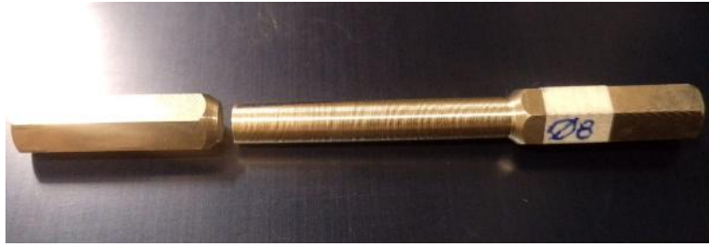
Figura 74. Primera probeta N9 en bronce naval luego del ensayo.
