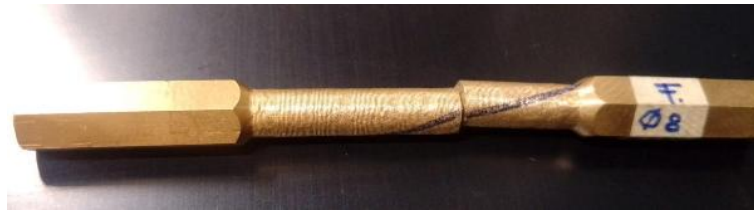
Figura 71. Primera probeta N9 en bronce fosfórico luego del ensayo.
