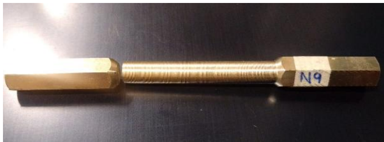
Figura 76. Tercera probeta N9 en bronce naval luego del ensayo.
