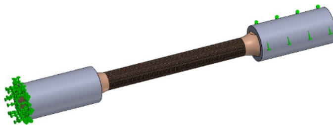
Figura 62. Lado fijo y lado rotacional de la probeta N10.
