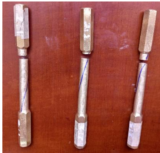
Figura 68. Ensayo de probetas de bronce fosfórico N10.
