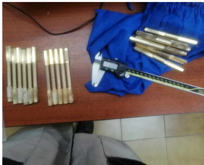
Figura 43. Probetas mecanizadas y sin mecanizar.
