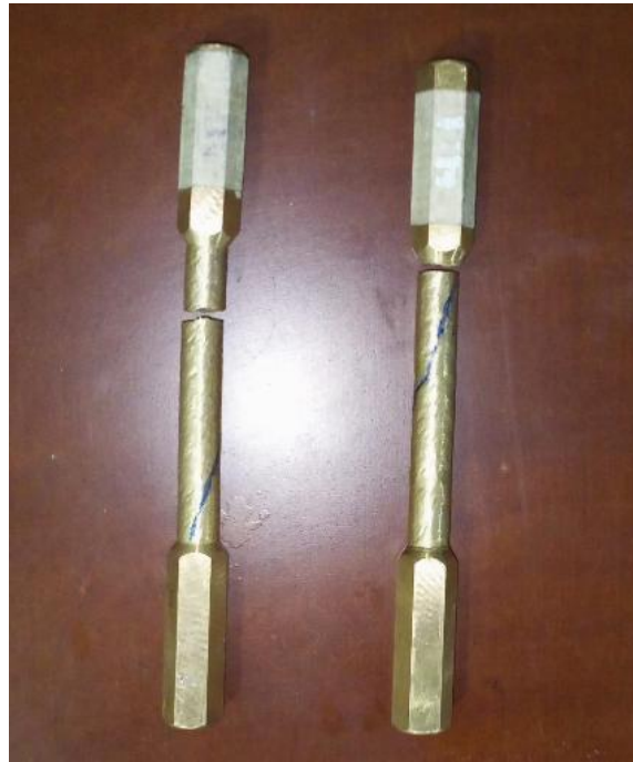
Figura 69. Ensayo de probetas N7 en bronce fosfórico.
