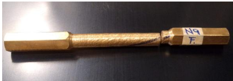
Figura 72. Segunda probeta N9 en bronce fosfórico luego del ensayo.
