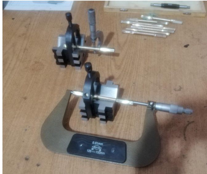
Figura 44. Medición de las probetas para corroborar medidas.
