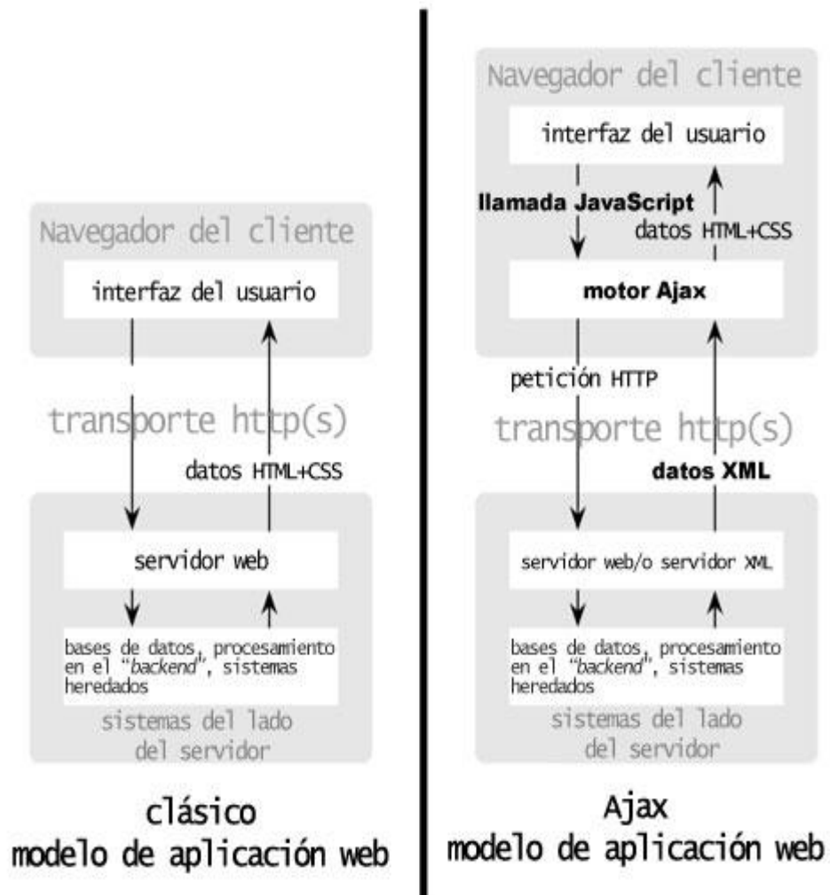
Figura #1: Esquema descriptivo de funcionamiento de Ajax
