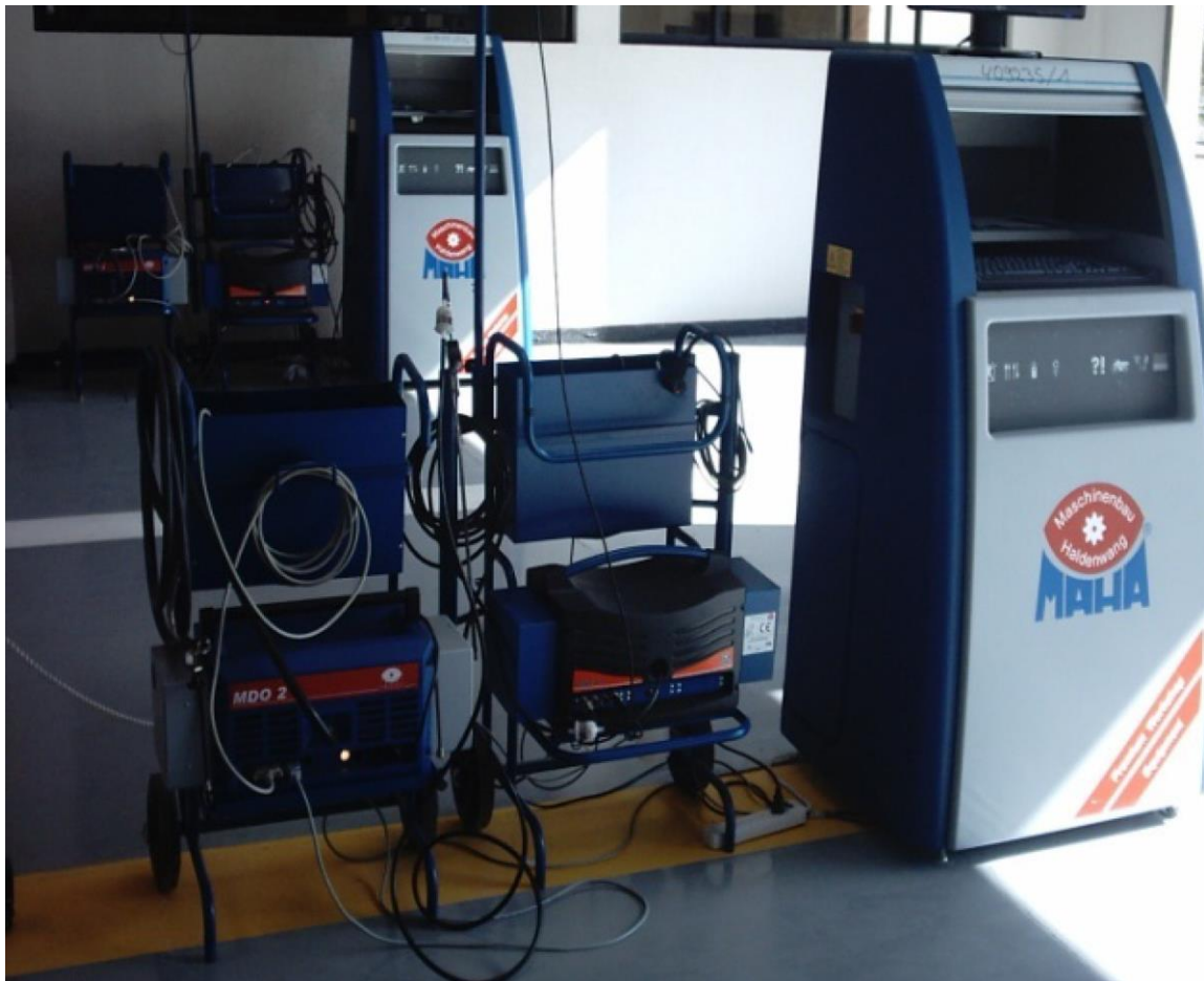
Ilustración 12: Opacímetro y analizador de gases.
