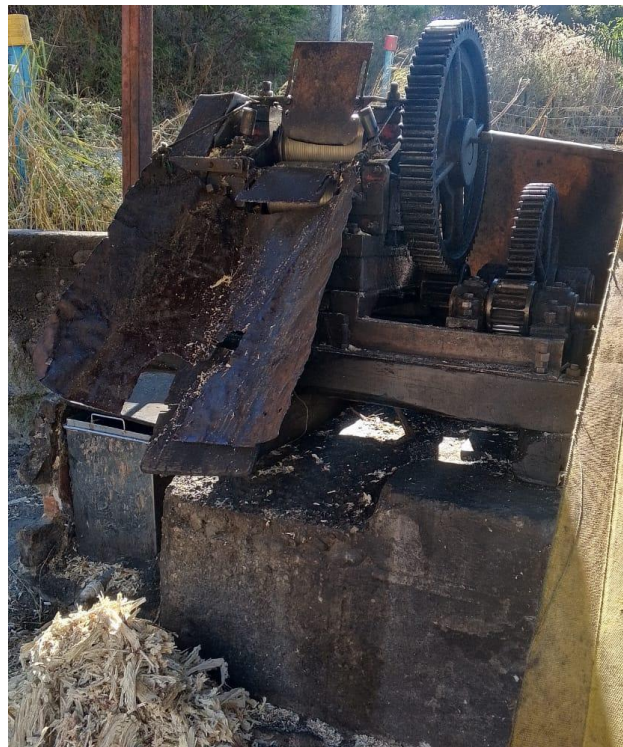
Figura 2: Trapiche para la extracción del jugo de caña para la posterior, fermentación y destilación.
