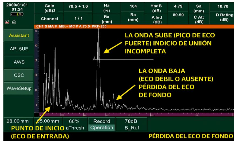
Figura 55.- Señal ultrasónica en A-1 y B-1 con indicio de unión incompleta
