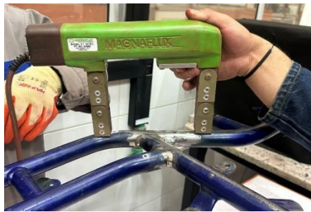
Figura 126.- Comprobación de la sensibilidad del yugo para fallas subsuperficiales en CC
