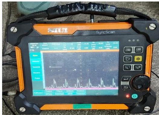
Figura 140.- Calibración y verificación del ángulo
