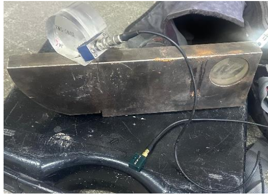
Figura 139.- Patrón de calibración ultrasónica sobre la zapata metálica
