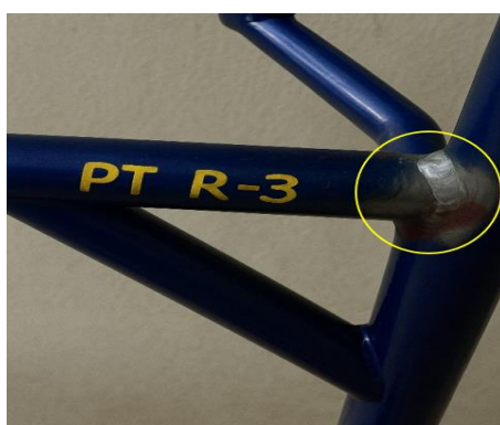
Figura 45.- Junta A-3 (inferior) con porosidad detectada por líquidos penetrantes (PT)
