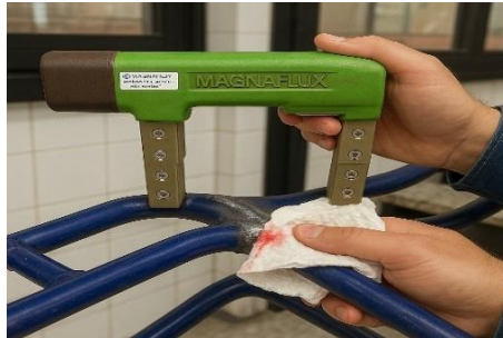
Figura 134.- Limpieza de zona de soldadura
