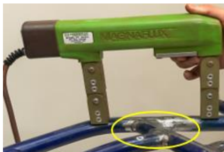
Figura 133.- Aplicación del yugo sobre el cordón
