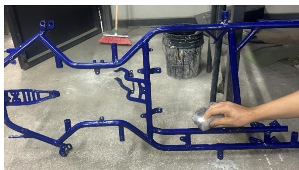
Figura 143.- Chasis del Karting N.º 252 tras limpieza superficial
