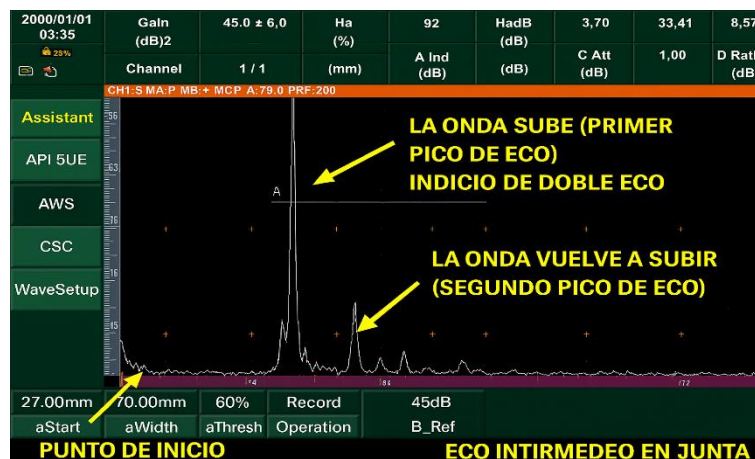
Figura 60.- Registro en A-6 y B-6 con doble eco en zona de inspección estructural
