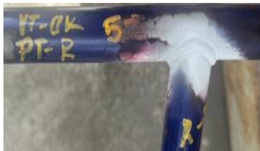
Figura 123.- Visualización de discontinuidades con revelador en unión soldada del chasis
