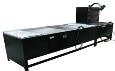
Figura 106.- Sistema de inspección por líquido penetrante fluorescente ZA-1633 A
