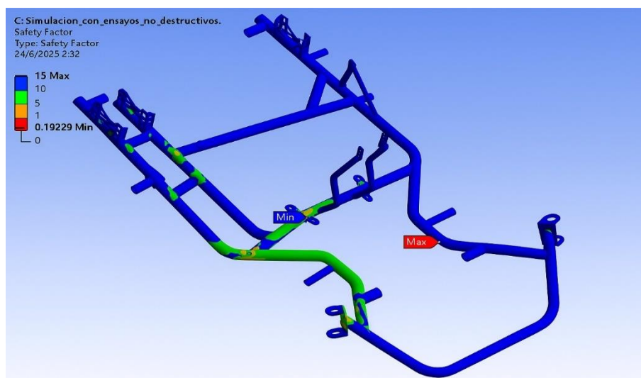
Figura 88.- Distribución del factor de seguridad en el chasis
