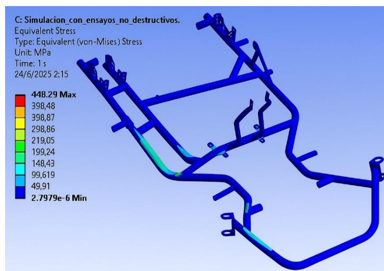
Figura 86.- Esfuerzo equivalente (Von Mises) en el chasis
