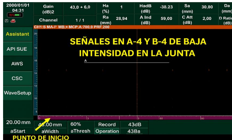
Figura 58.- Señales en A-4 y B-4 de baja intensidad en la junta evaluada (UT)
