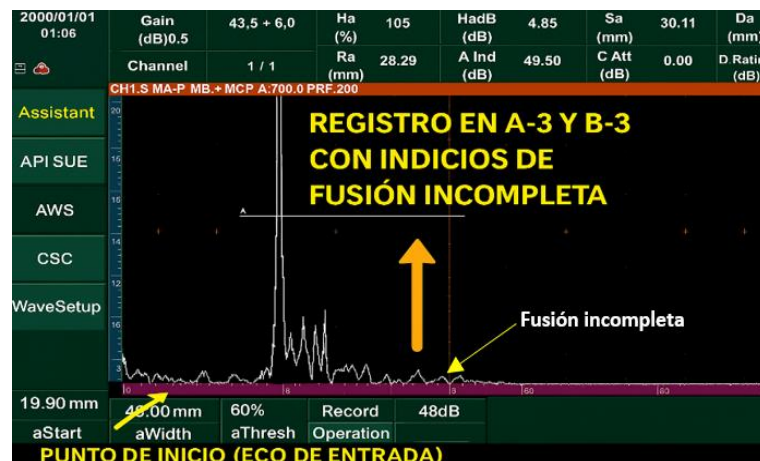
Figura 57.- Registro en A-3 y B-3 con indicios de fusión incompleta
