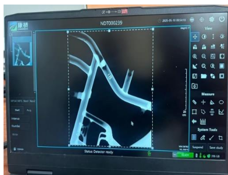
Figura 149.- Resultado radiográfico digital de soldadura en chasis
