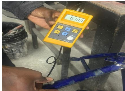
Figura 141.- Aplicación de acoplante sobre el chasis
