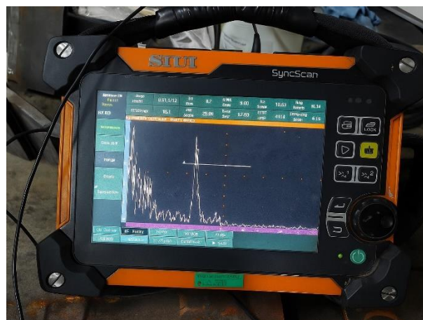
Figura 32.- Evaluación por ultrasonido (UT) de los tubos del chasis.
