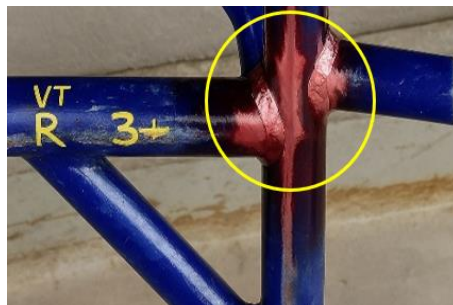
Figura 41.- Junta A-3 (inferior) con porosidad agrupada detectada (VT-R)
