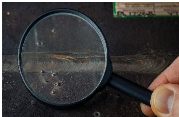
Figura 7.- Inspección Visual (VT)
