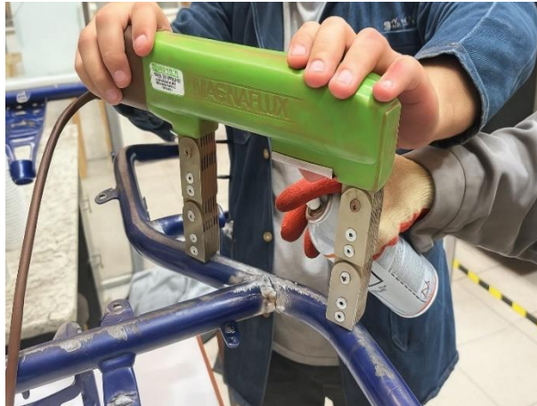
Figura 30.- Inspección por partículas magnéticas (MT) en zonas ferromagnéticas
