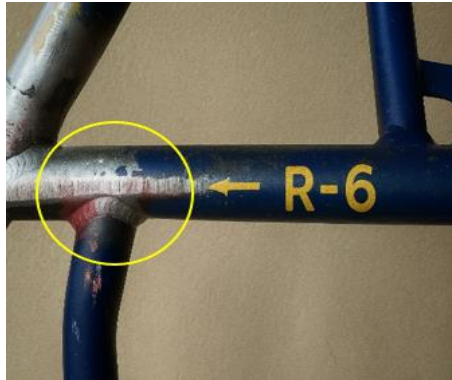
Figura 46.- Junta A-6 (inferior) con mordedura detectada por líquidos penetrantes (PT)
