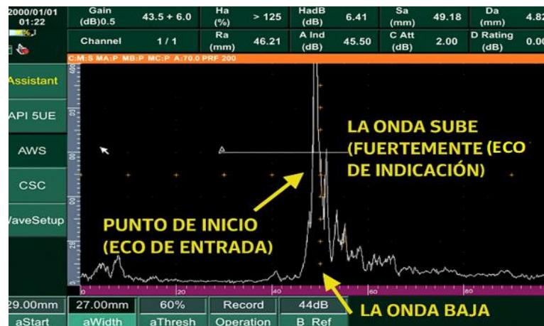
Figura 56.- Registro en A-2 y B-2 con eco indicativo de falta de penetración
