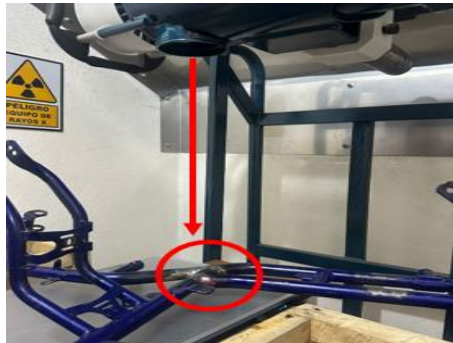
Figura 148.- Disparo de rayos X sobre chasis desde consola de control.
