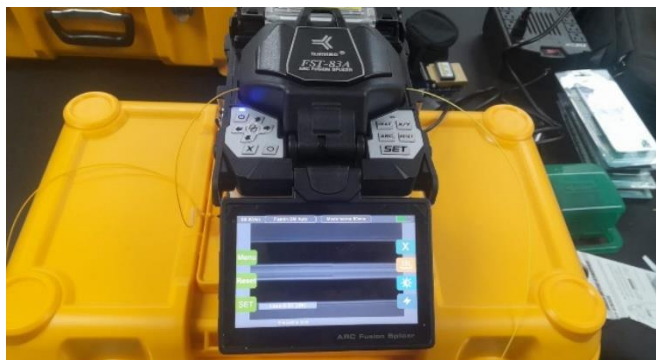
Fig. 19 Fibra correctamente fusionada con un corte adecuado.
