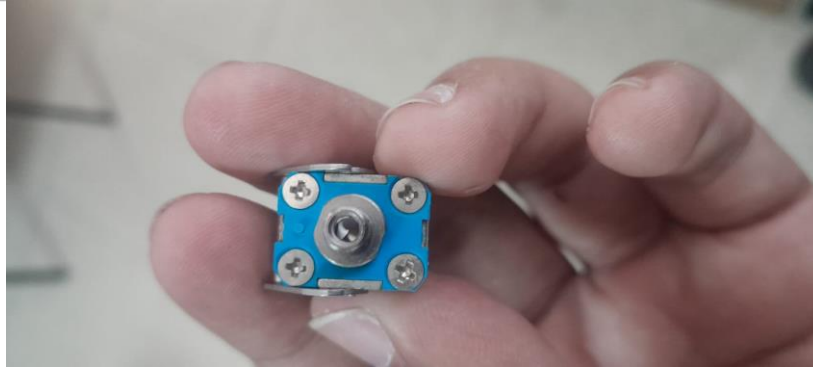
Fig. 36 Férula rota en el centro del adaptador.
