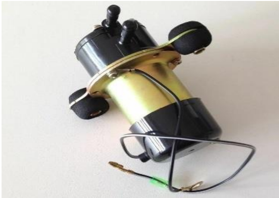
Bomba de combustible diésel de baja presión
