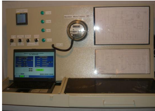
Figura 48. Módulo de contrastación armado.
