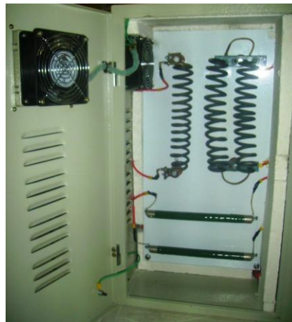
Figura 67. Vista interna de las resistencias del equipo de contrastación.
