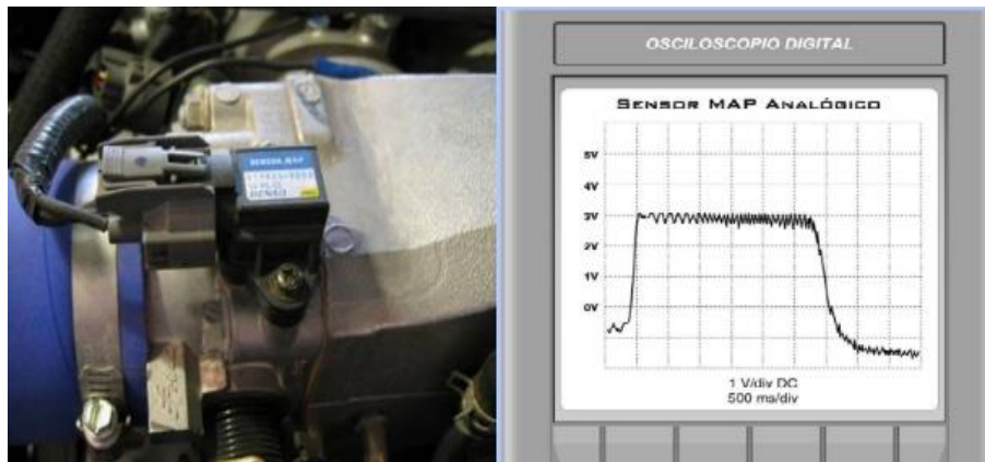
Figura 14. Sensor MAP ubicación y señal característica en un osciloscopio.
