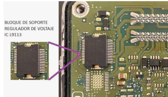
Figura 14. Bloque de Soporte o circuito fuente de la ECU.
