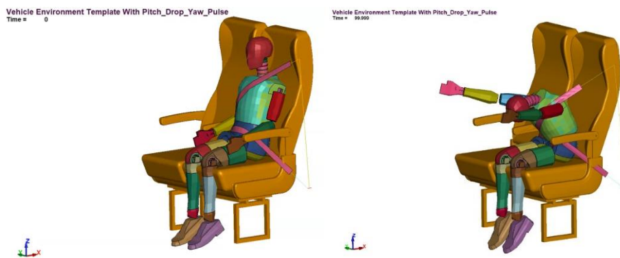
Figura 16. Simulación de impacto al usuario en el asiento del modelo Scania K410
