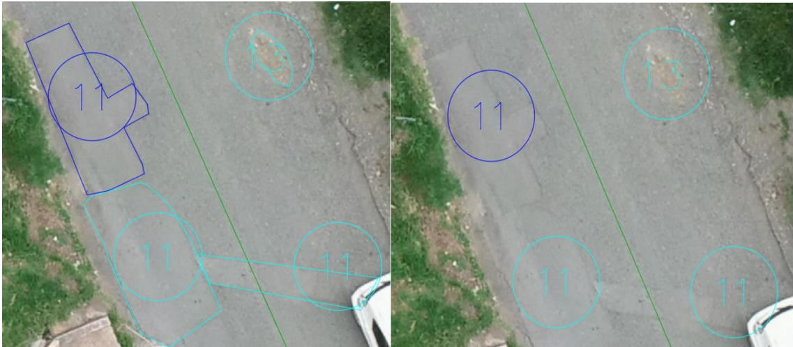
Figura 8: Determinación de tipo de falla y magnitud con ortofoto (Elaboración Propia)
