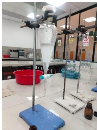
Figura 6. Uso del Equipo de Decantación
