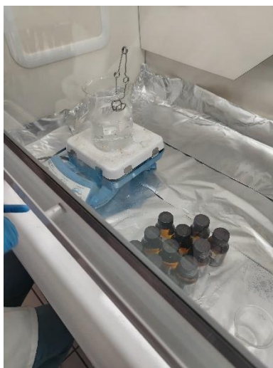
Figura 7. Baño María para la Evaporación del Cloroformo
