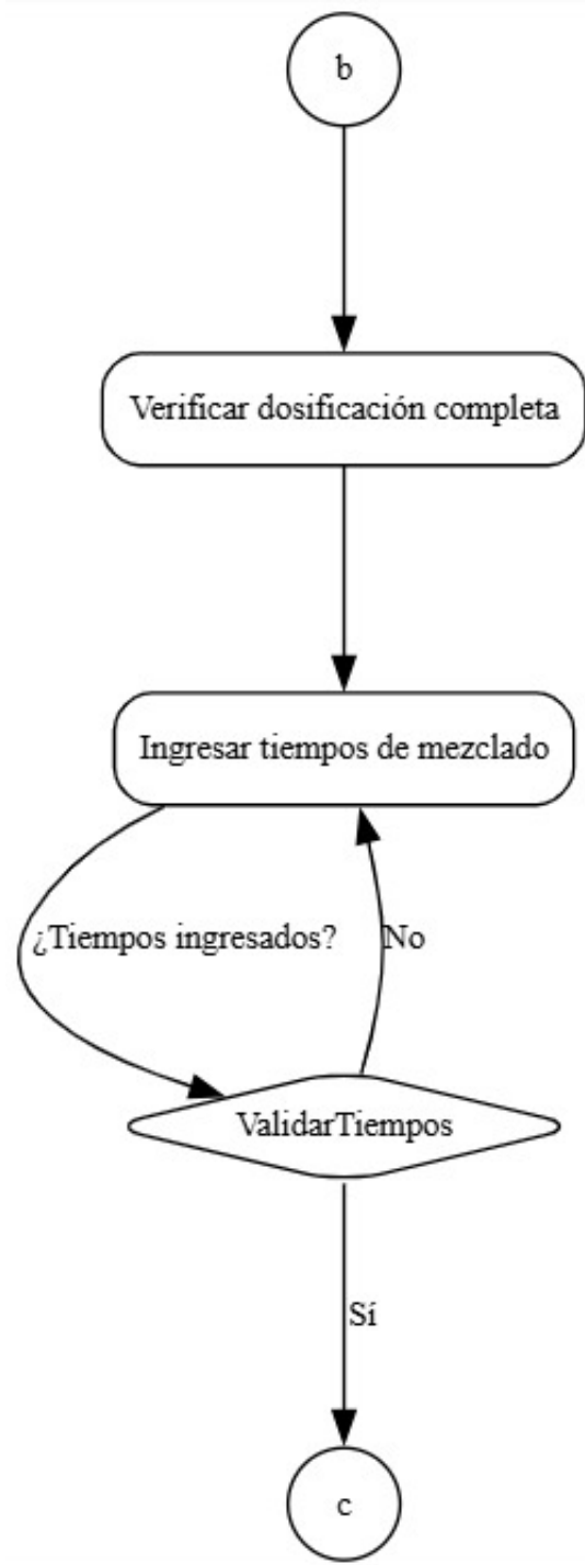
Figura 3.3: Diagrama de verificación e ingreso de tiempos de mezclado- Parte 1
