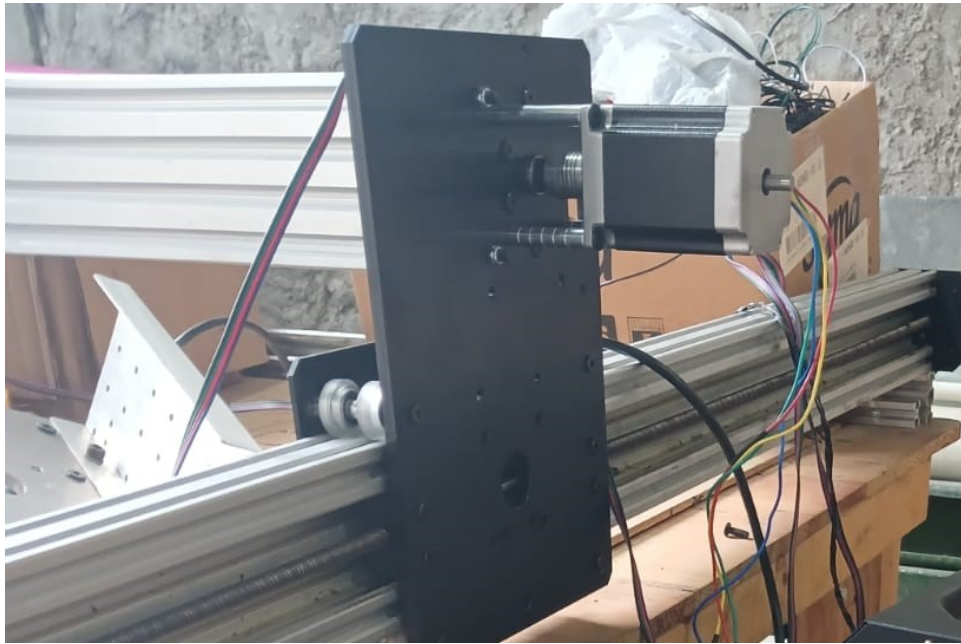
Figura 39. Cableado motor eje Y
