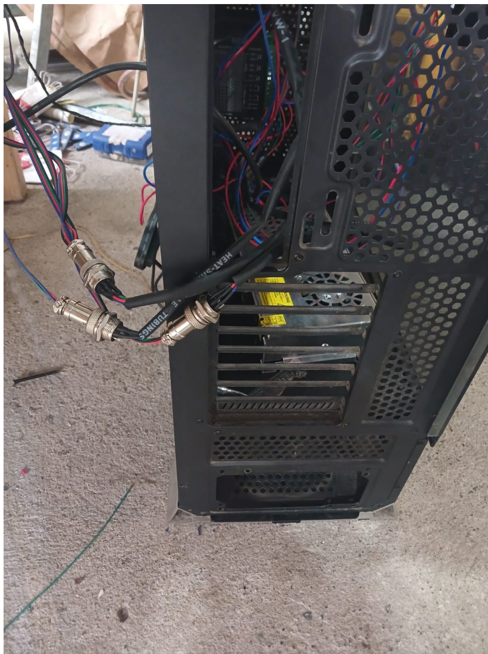
Figura 38. Conexión por socket entre los motores y drivers
