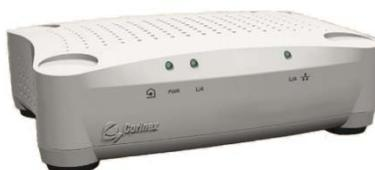
Este módem es una interface de red capaz de usar el cableado eléctrico existente como medio de comunicación, este puede ser usado como una LAN tradicional con una velocidad de transmisión de hasta 200 Mbps. Tiene un bajo costo de mantenimiento. Las especificaciones técnicas las mostramos a continuación:
