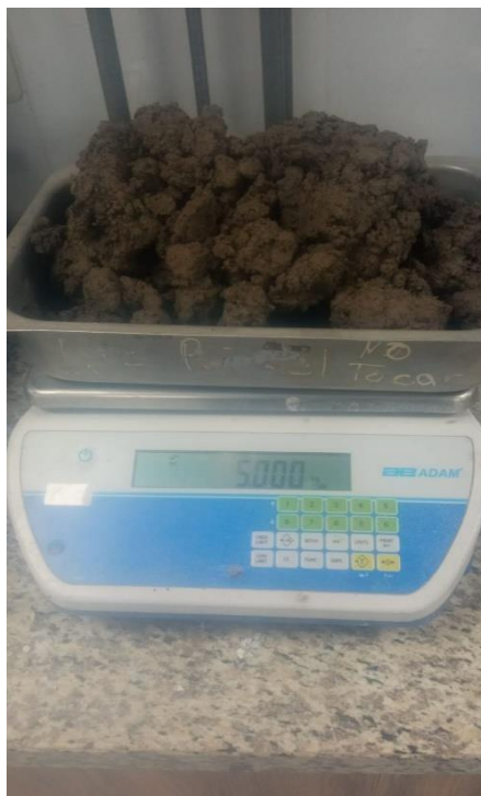
Anexo C. Toma de Muestra Para Ensayo de Granulometría Pozo 1
