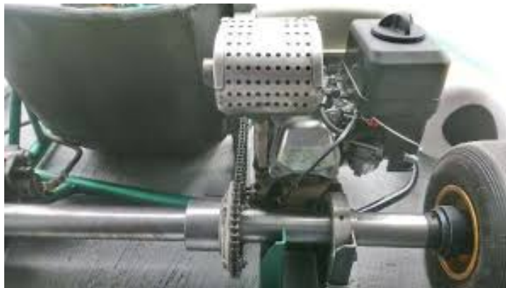
Figura 1. Vista del sistema de transmisión en Go-Kart, mostrando el eje trasero, piñón y cadena conectados al motor de combustión interna [8].
