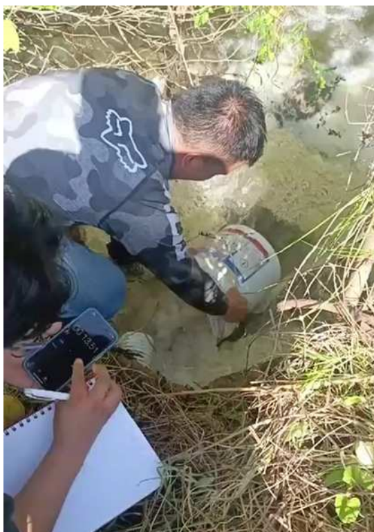
(a) Medición del caudal de agua con un balde de 20 litros de capacidad.
