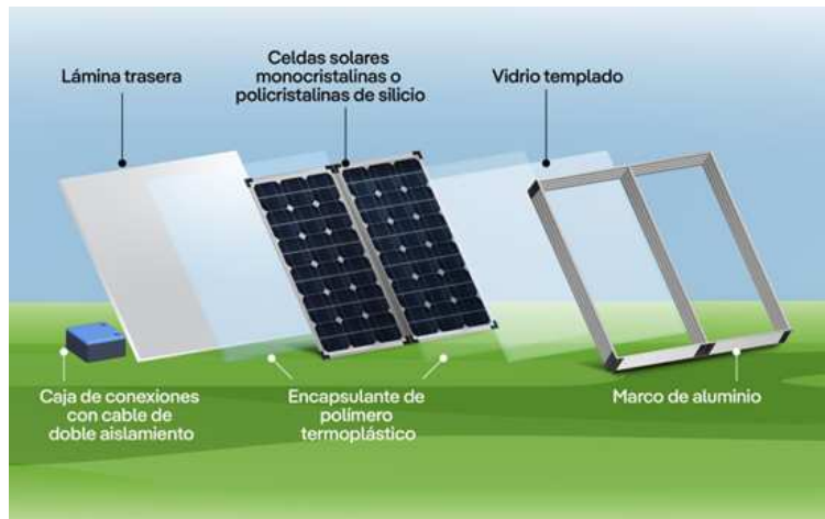
Figura 2.10: Partes de un panel solar [?].
