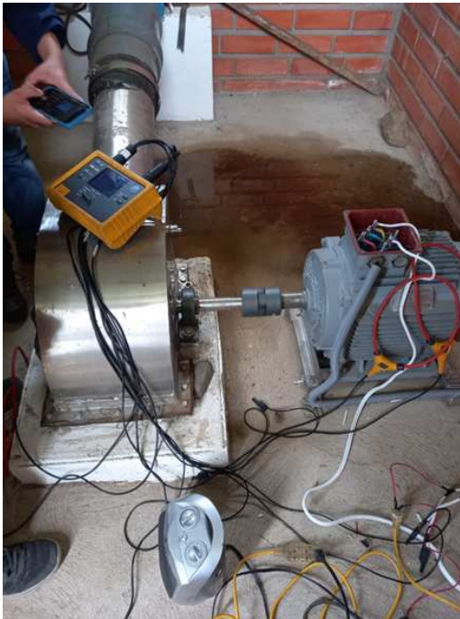
(a) Analizador de calidad eléctrica y de redes de la marca FLUKE.
