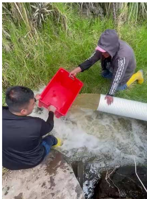
(b) Medición del caudal de agua usando una gaveta de 40 litros de capacidad.
