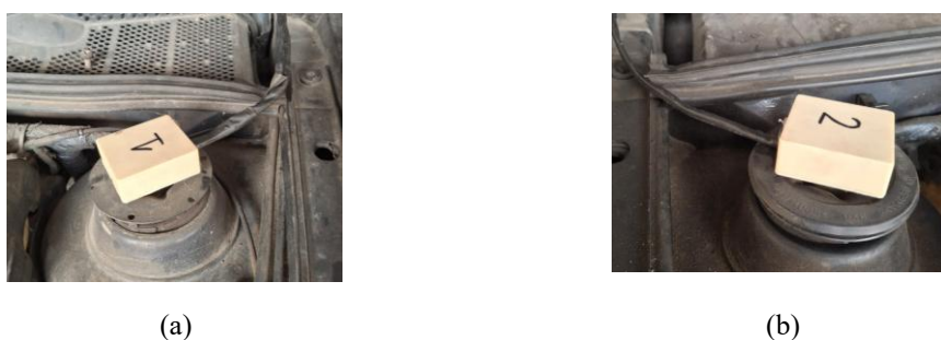
Figura 2. (a) Acelerómetro en torre izquierda (b) Acelerómetro en torre derecha.
