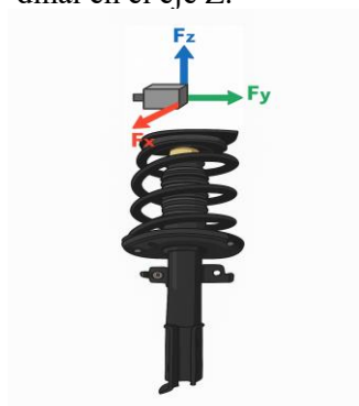
Figura 3. Representación gráfica de amortiguador con sus ejes
