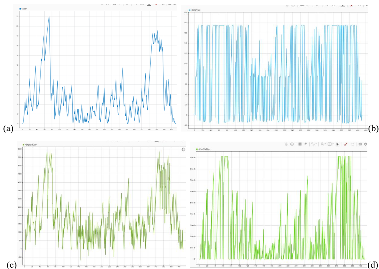
Fig. 11. Gráficas de desempeño del vehículo en un ciclo de conducción media: a) velocidad del vehículo b) par motor c) salida de velocidad del motor d) flujo volumétrico de combustible.
