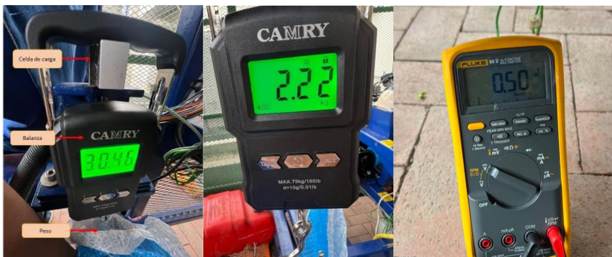
Fig. 24. Proceso de calibración de celda de carga.
