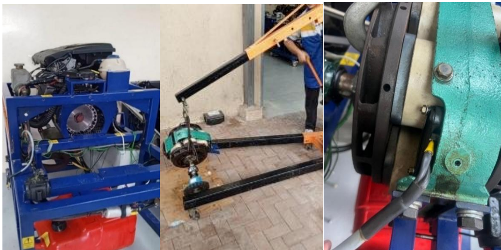
Fig. 17. Desmontaje y mantenimiento preventivo del freno electromagnético.
