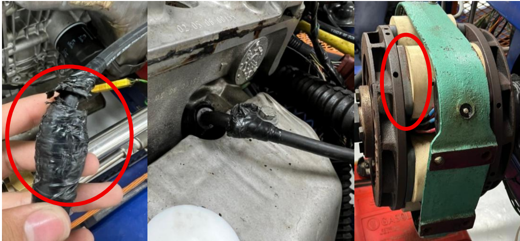
Fig. 13. Cables de bujías rotas y presencia de oxido en el freno electromagnético.
