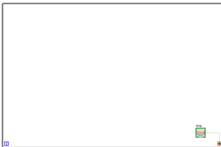
Fig. 39. While Loop con control de parada en LabVIEW.
