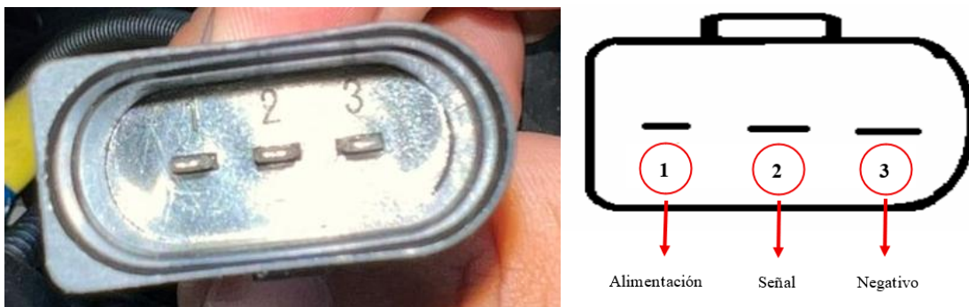
Fig. 26. Pin del sensor de posición del cigüeñal (CKP).
