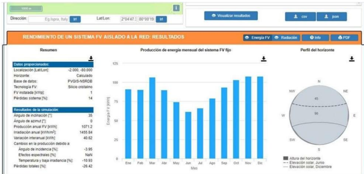
Imagen 8. Rendimiento del sistema fotovoltaico simulado en el programa PVGIS. Fuente: [17]; [16]
