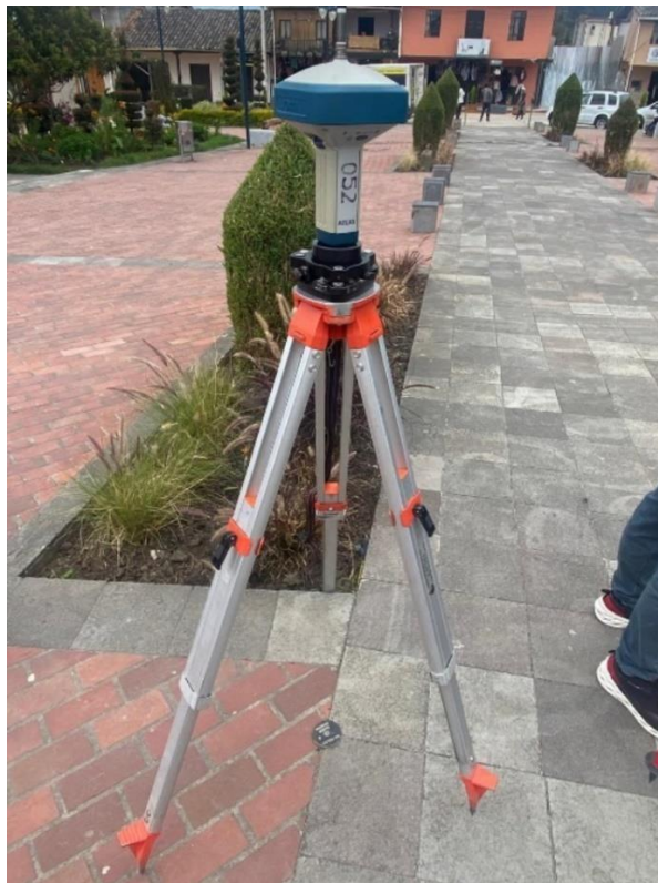
Fotografía 8 Instalación de la base para la recolección de información (GPS) en el parque central de Nabón.
