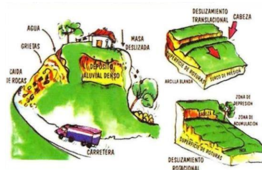
Imagen 4 Causas de los deslizamientos Fuente: (CREPAD - BOYACÁ, 2012)
