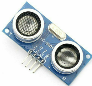
Figura 24. Sensor ultrasónico hc-sr 04 [68]
