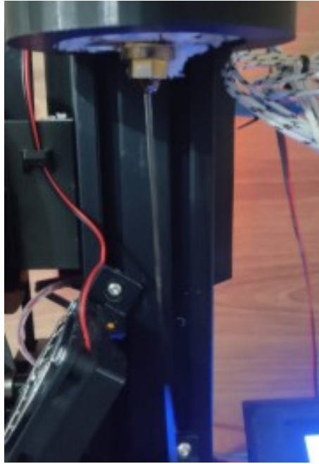
Figura 119. Extrusión de filamento reciclado. Fuente propia.
