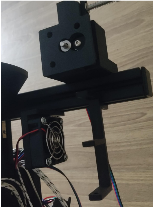
Figura 96. Ventilador de enfriamiento 2. Fuente propia
