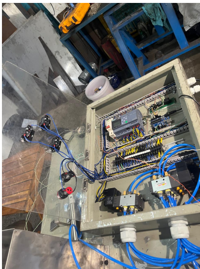
Figura 37. Diseño general implementado neumático y sensores a Logo!.
