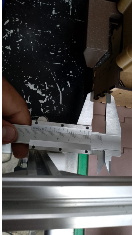
Figura 86. Medición con calibrador digital del desfase de las cajas.Fuente: Autores
