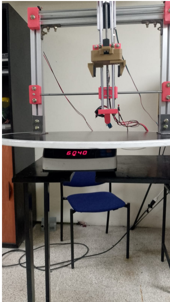
Figura 64. Cálculo del Peso del Sistema Pick and Place en el Análisis Estructural de la Mesa. Fuente: Autores
