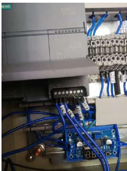
Figura 120. Conexión de la celda de carga al PLC Siemens S7 1200 : Los autores.
