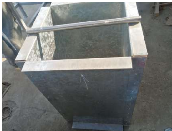
Figura 118. Doble de lamina galvanizada para crear cuello de la maquina trituradora: Los autores.
