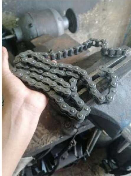
Figura 112. Corte de cadena a la medida necesaria Fuente: Los autores.
