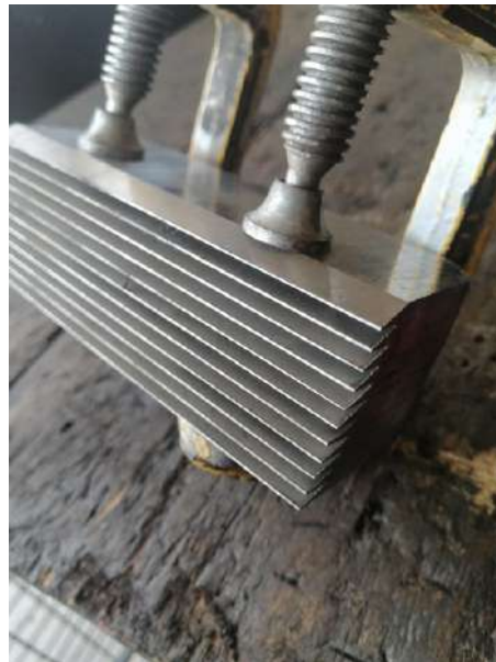
Figura 115. Cuchillas cortadas y afiladas: Los autores.
