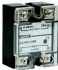
Figura 9. Relé de estado sólido (SSR) - MAXGE [26]
