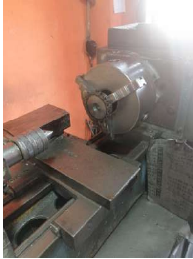
Figura 108. Los engranajes siendo mecanizados. Fuente: Los autores.
