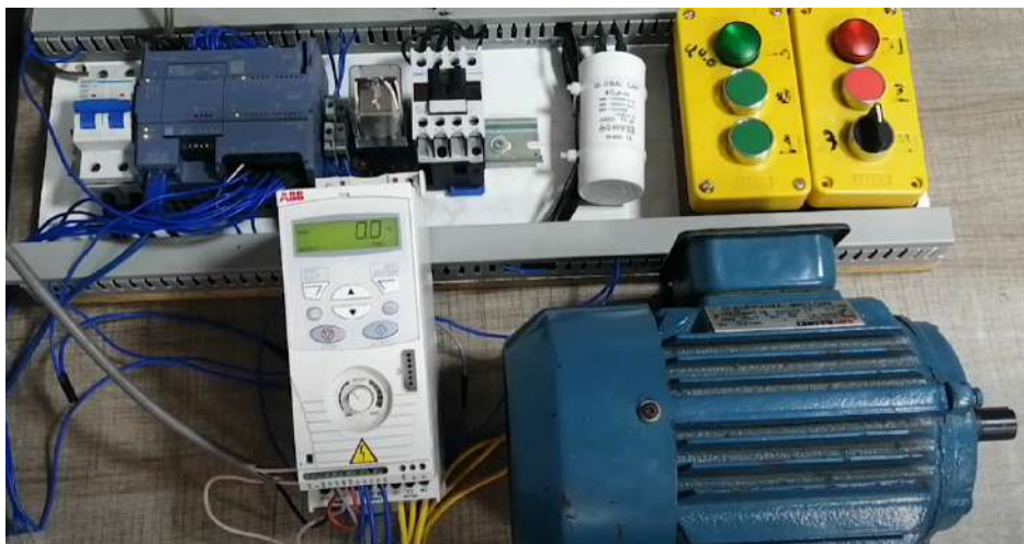
Figura 42. Control variador de frecuencia - PLC- motor trifásico [10]
