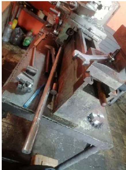
Figura 109. creación de espacio en el eje para dar paso a la cuña Fuente: Los autores.
