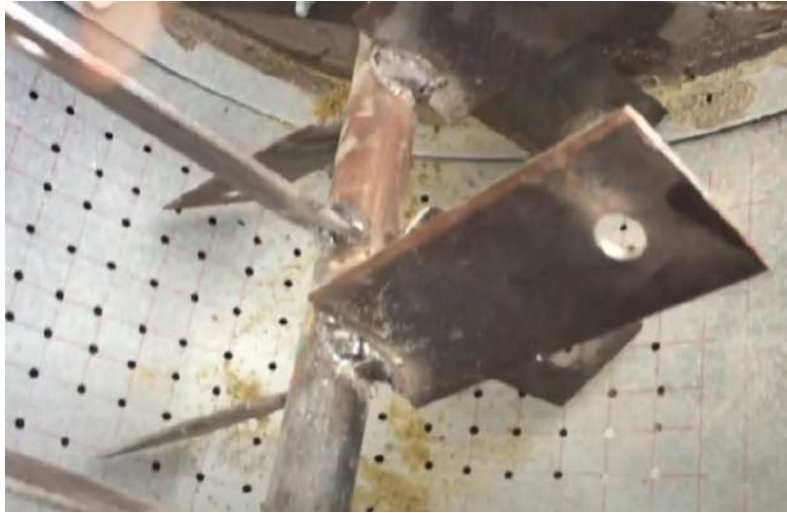
Figura 37. Soleras con agujero ajustada al eje [11]
