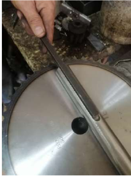
Figura 110. Comprobación de longitud de cuña: Los autores.
