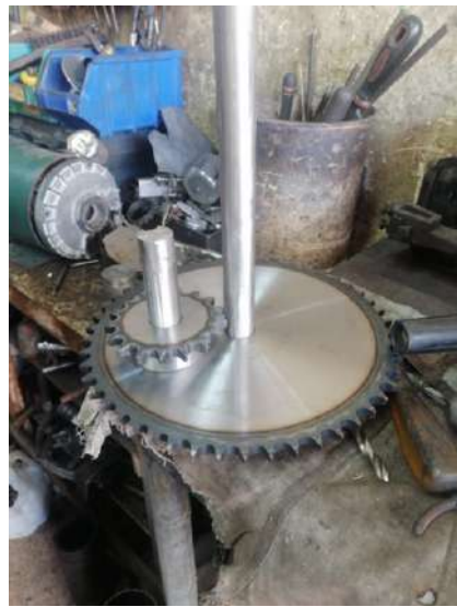
Figura 111. Unión del eje con los engranajes: Los autores.
