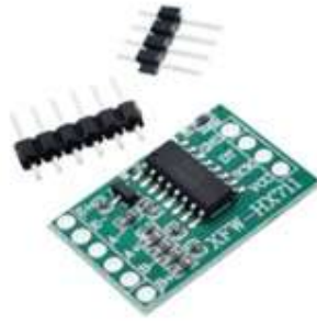
Figura 26. Módulo de amplificación [56]
