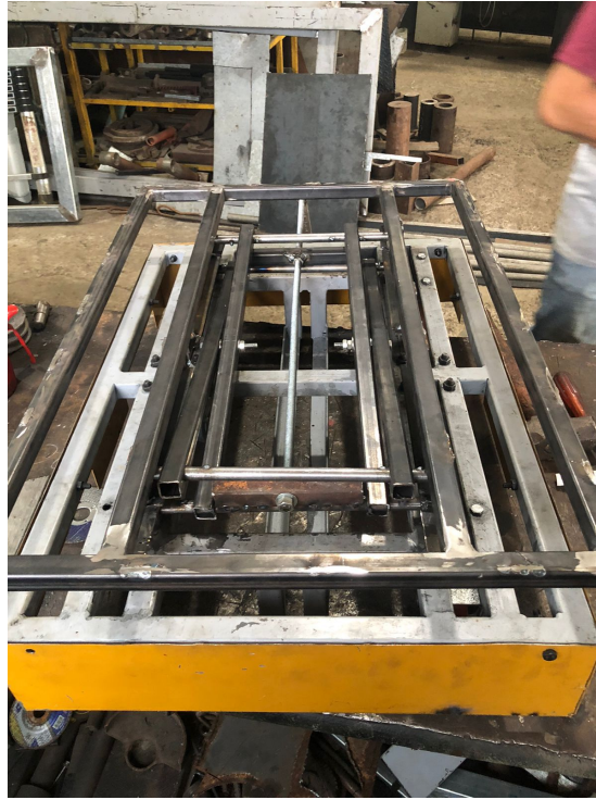
Figura 59. Construcción de la Tijera Fuente: Propia
