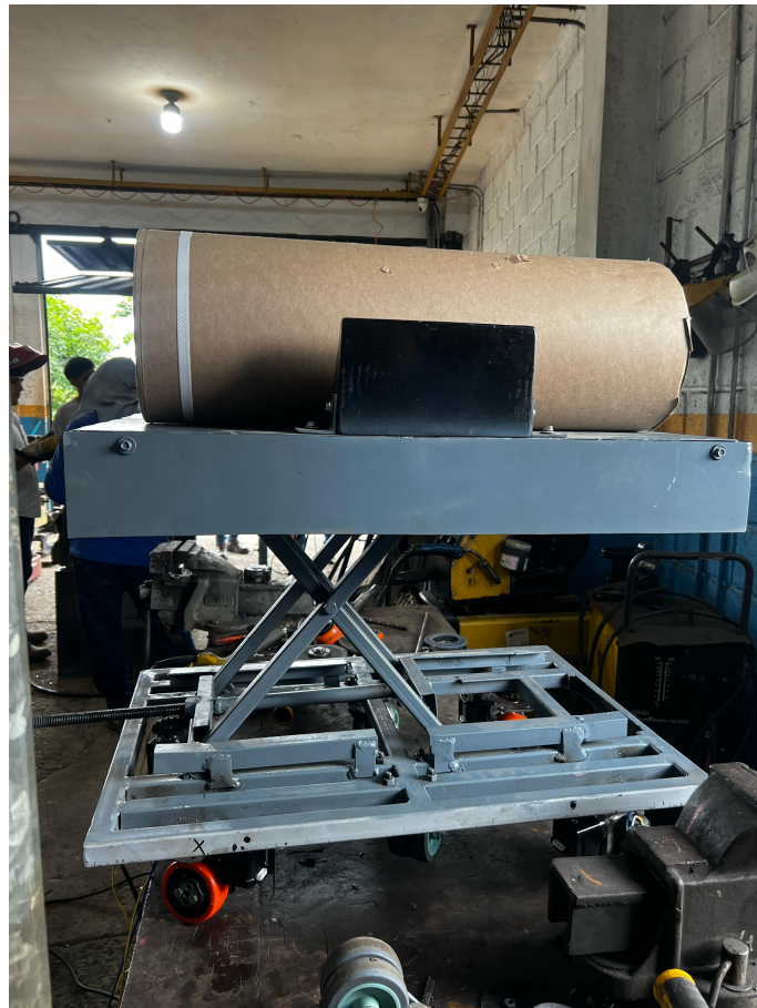
Figura 64. Elevación de tijera con carga de 12kg
