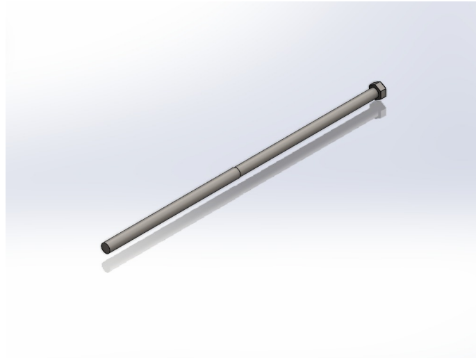
Figura 47. Diseño del Tornillo de Potencia en SolidWorks Fuente: Propia
