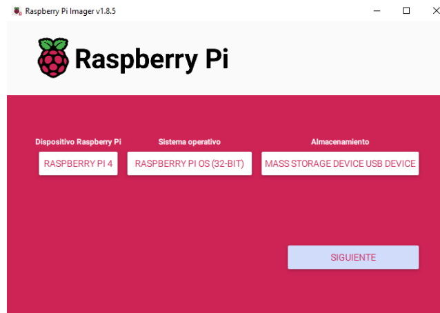
Fig.7.1. Instalación OS en Raspberry Pi Imager.
