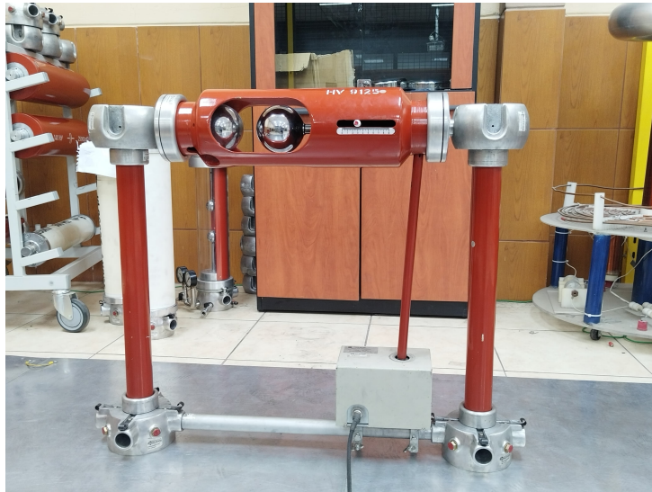
Figura 21: Esferas de interrupción (HV9125) y separador de esferas (HV9126) del laboratorio de alta tensión
