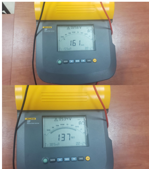
Figura 45: Valores de resistencia del diodo de 140 kV en polarización directa (parte superior) e inversa (parte inferior)
