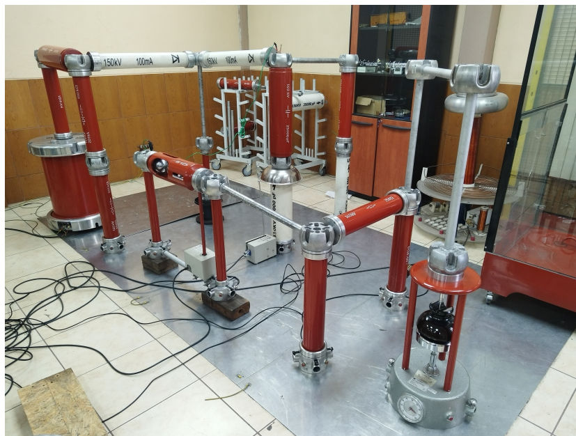
Figura 61: Ensayo Doblador de Tension mas ensayo BIL Final
