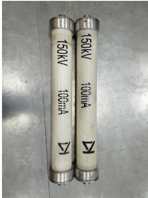
Figura 13: Diodos con capacidad de 150 kV del laboratorio de alta tensión
