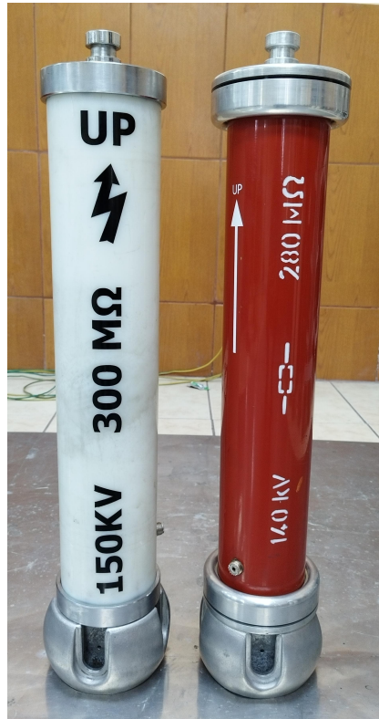
Figura 19: Partidor resistivo HV9113 y partidor resistivo 300MΩ del laboratorio de alta tensión
