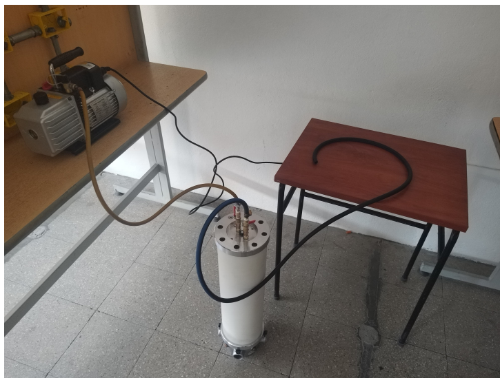
Figura 55: Proceso de llenado al vacío con aceite dieléctrico en los condensadores de 150 kV
