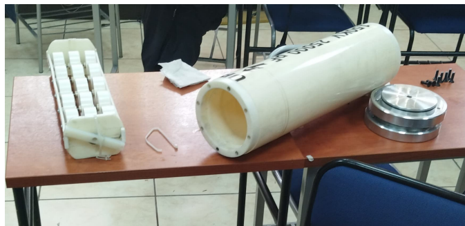
Figura 49: Proceso de desmontaje del condensador de 150 kV
