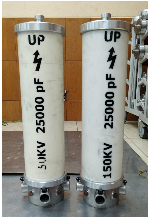
Figura 17: Capacitores de 25000 pF con tensión nominal de 150 kV del laboratorio de alta tensión.
