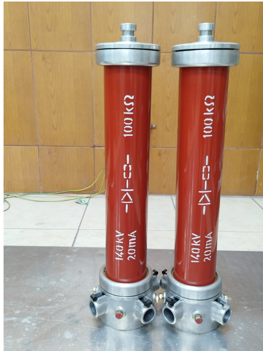
Figura 12: Diodos del laboratorio de alta tensión
