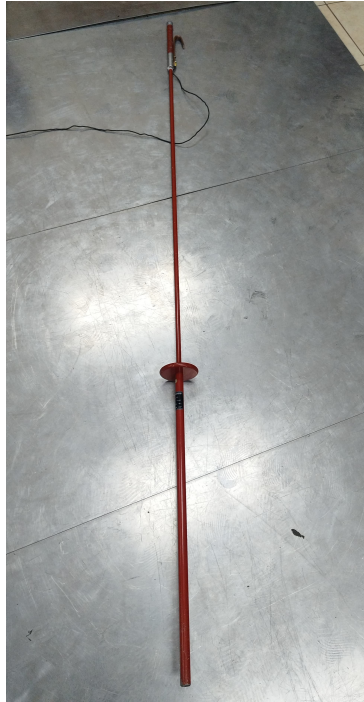
Figura 20: Pertiga del laboratorio de alta tensión
