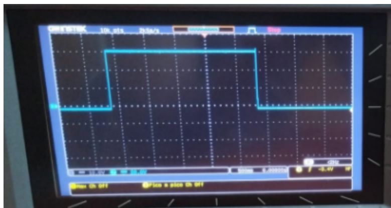
Figura 52: Forma de onda obtenida del condensador con funcionamiento defectuoso
