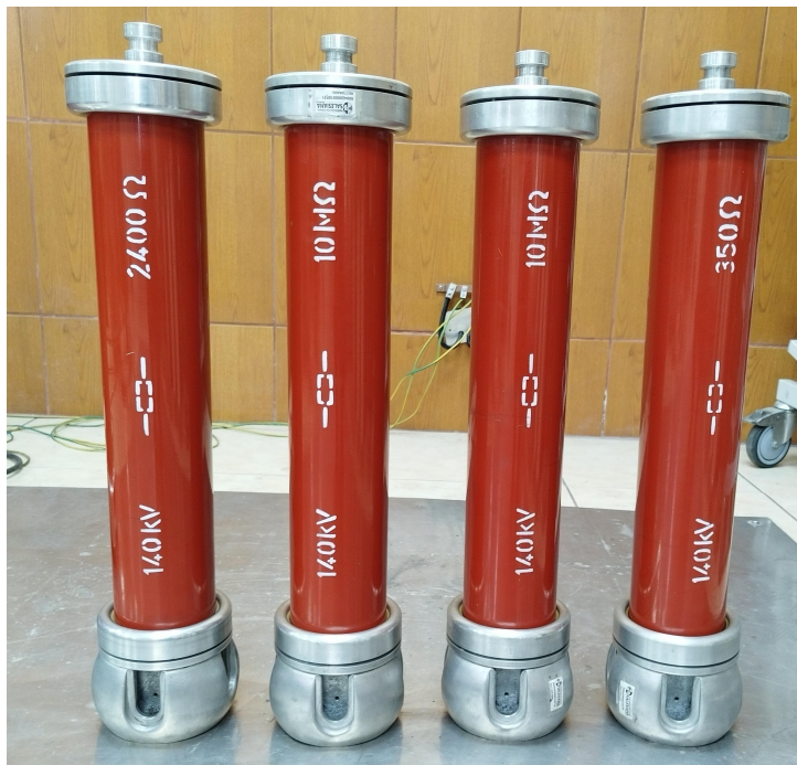
Figura 18: Resistencias y partidor resistivo HV9113 del laboratorio de alta tensión
