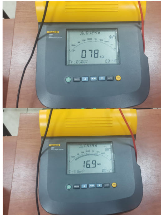
Figura 46: Valores de resistencia del diodo de 150 kV en polarización directa (parte superior) e inversa (parte inferior)
