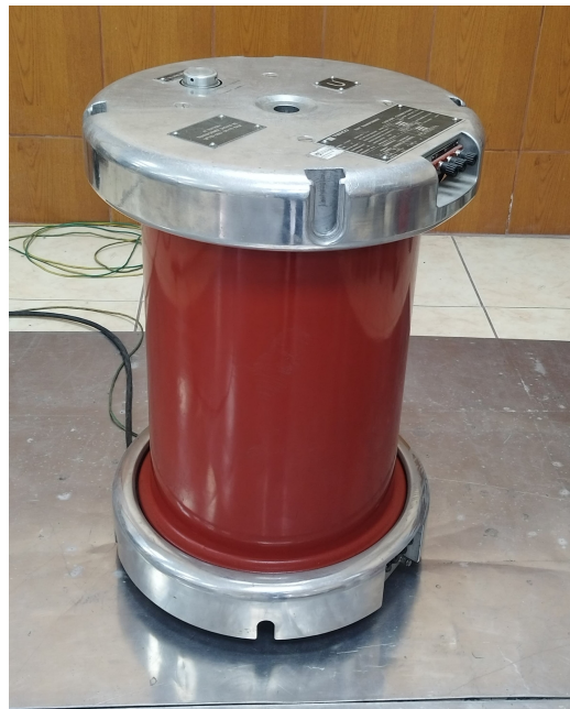
Figura 2: Transformador de pruebas del laboratorio de alta tensión
