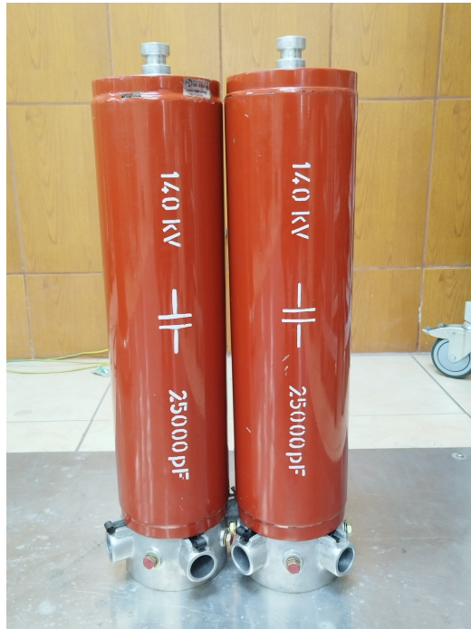
Figura 14: Capacitores HV9112 del laboratorio de alta tensión
