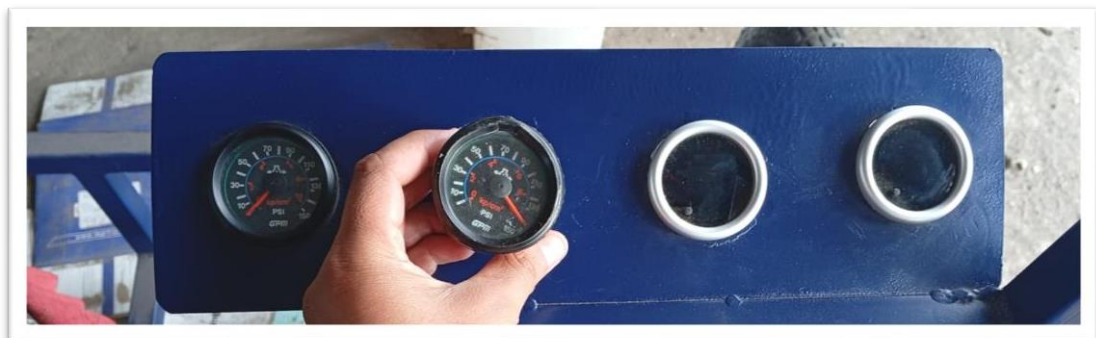
Figura 4.14: Medidores de presión y medidores de temperatura
