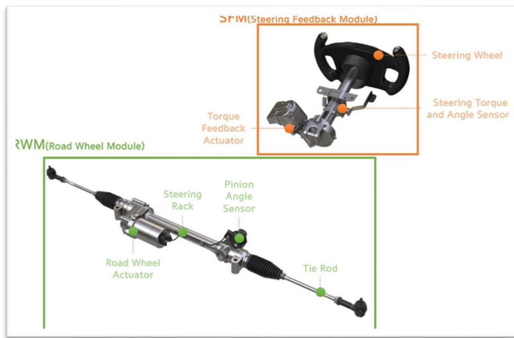
Figura 1.9: Sistema de dirección por cable
