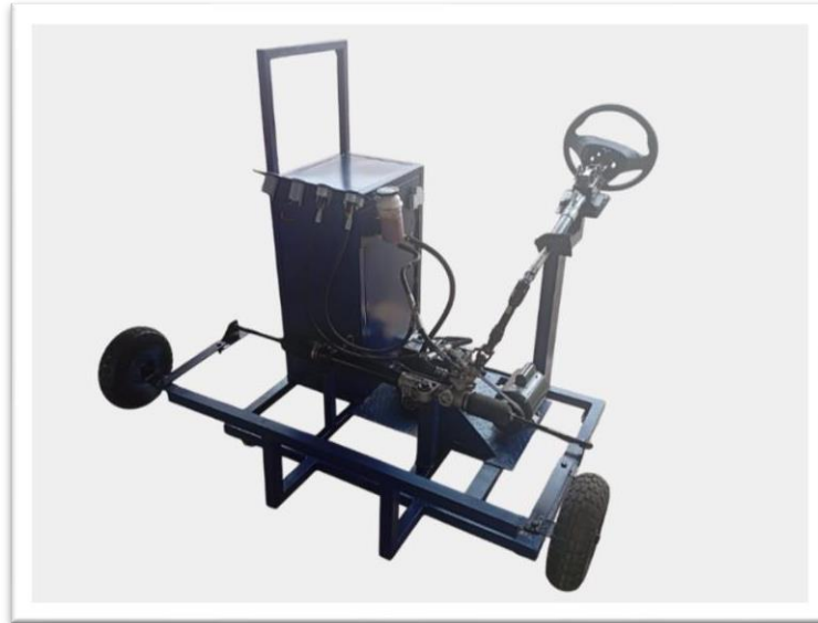
Figura 5.3: Banco didáctico de dirección hidráulica
