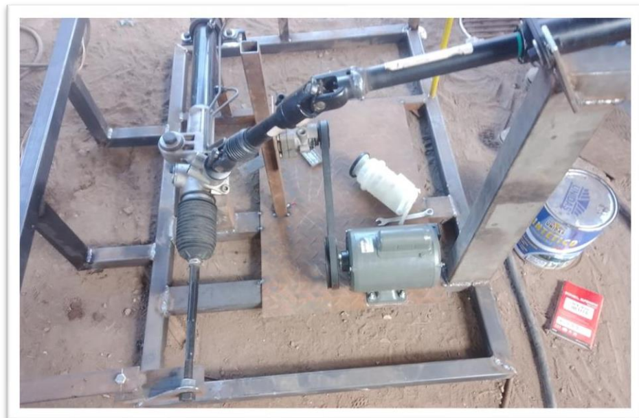
Figura 4.23: Soldadura de platina base de bomba de dirección, batería de 12V y motor eléctrico
