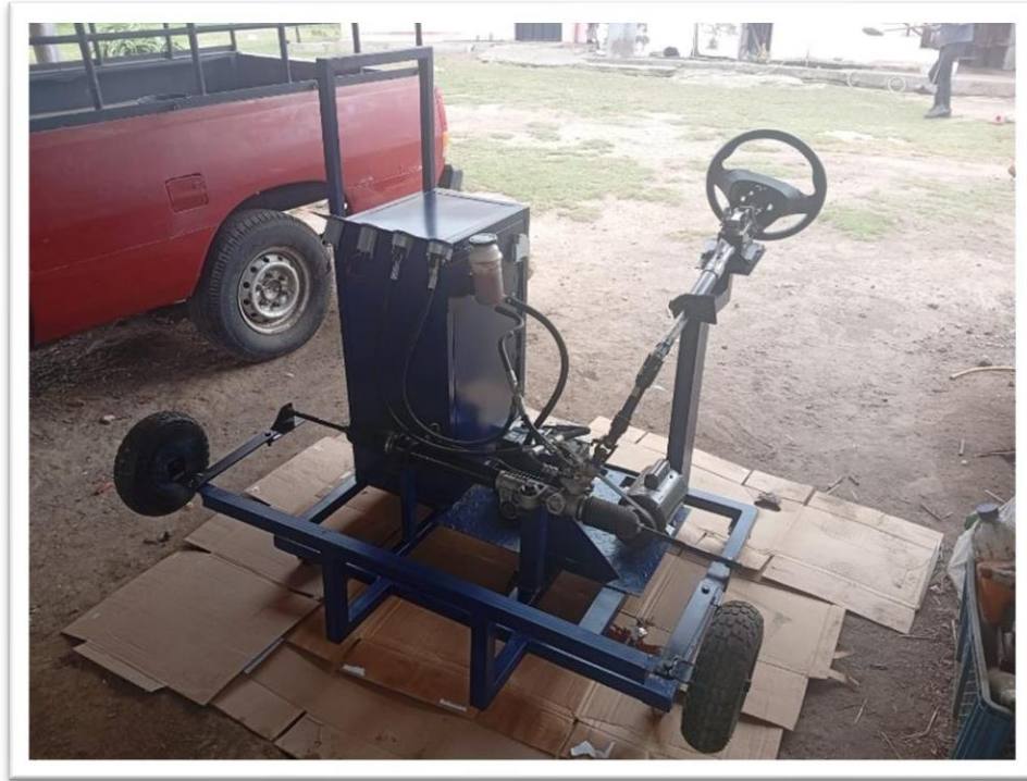
Figura 4.40: Banco didáctico de un sistema de dirección hidráulica de vehículos tipo M1
