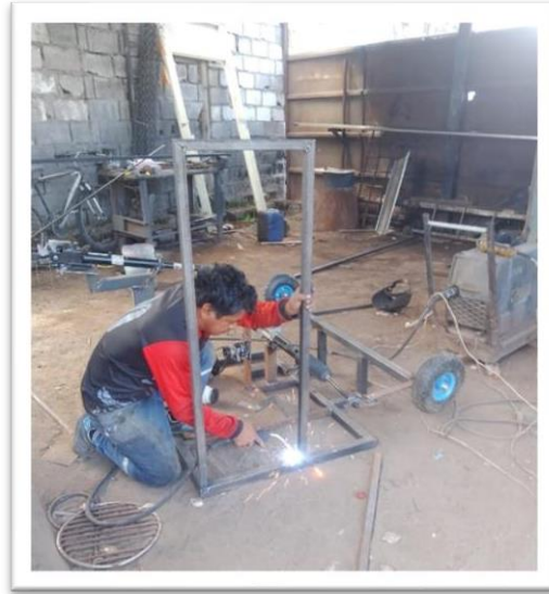
Figura 4.22: Soldadura de la cajonera
