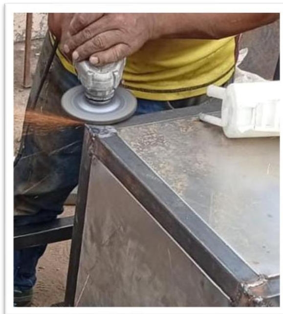
Figura 4.29: Lijada y pulida de la estructura
