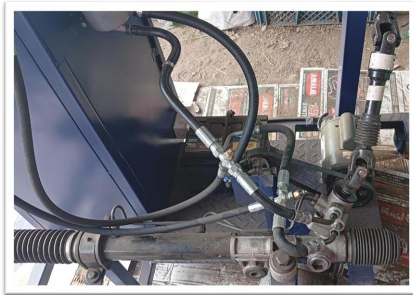
Figura 4.36: Instalación de líneas hidráulicas
