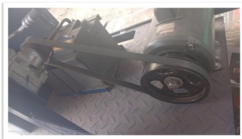
Figura 4.35: Colocación de banda de tres canales
