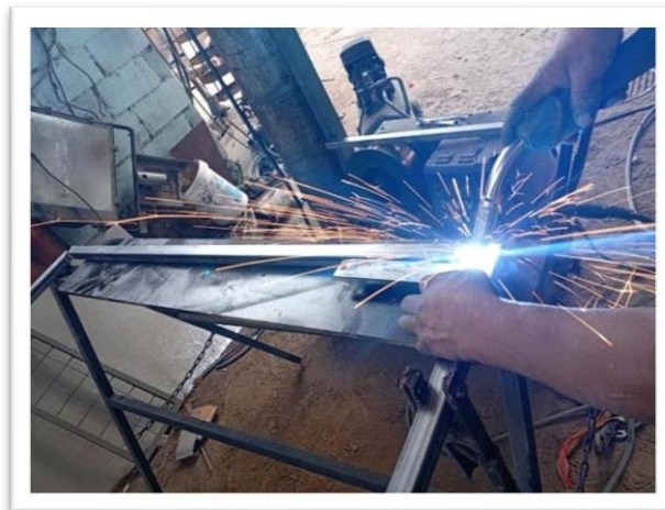
Figura 4.19: Soldadura de la base de la estructura
