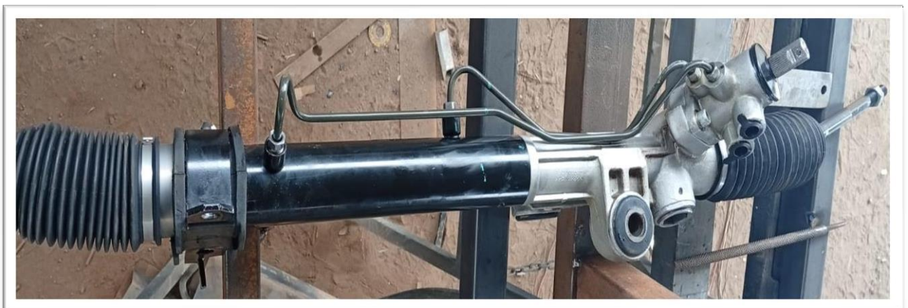
Figura 4.2: Caja de dirección tipo piñón y cremallera
