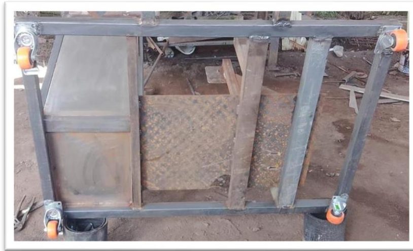
Figura 4.28: Soldadura de ruedas para movilidad
